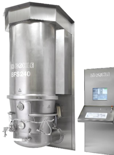
Ilustración 44. Secador de lecho fluidizado BFS 240 (L.B.Bohle, 2023b)
