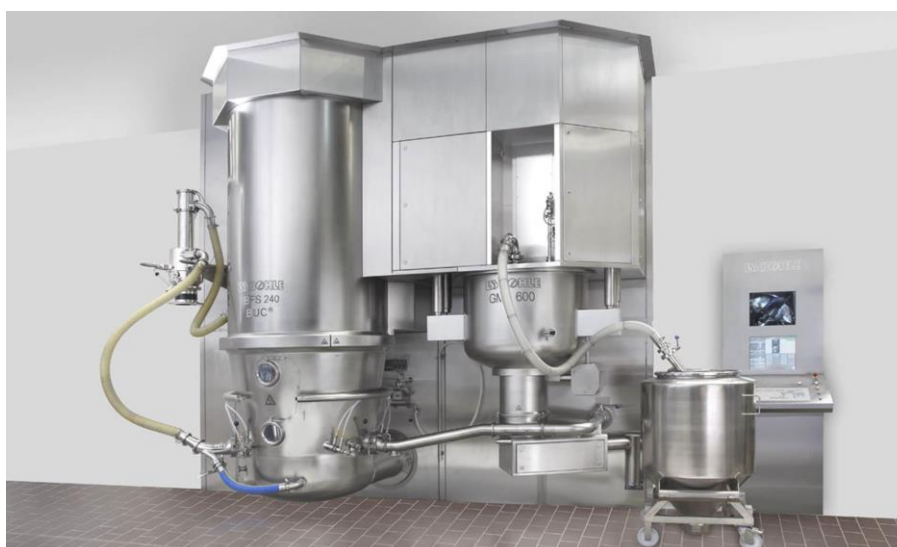
Ilustración 40. Granulación compacta BFS240 y GMA600 (L.B.Bohle, 2023a)
