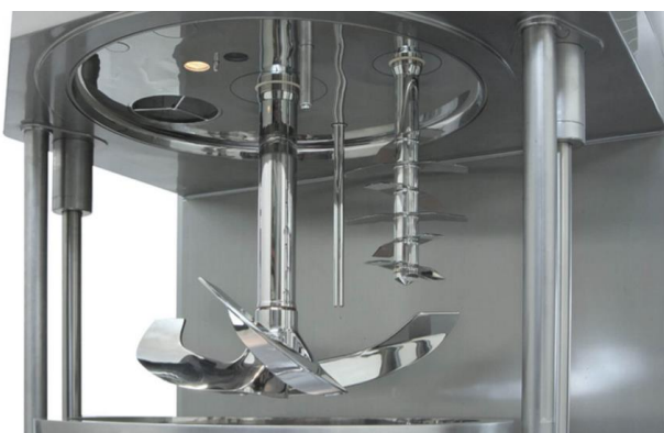
Ilustración 43. Cuchillas internas GMA 600 (L.B.Bohle, 2023c)
