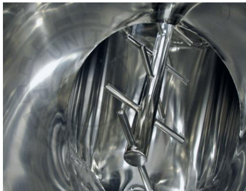
Ilustración 51. Interior mezclador tipo V - U-53 CBF (United Pharmatek, 2022a)
