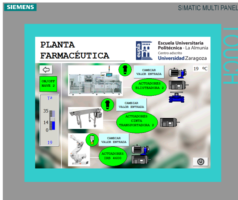
Ilustración 95. Acondicionamiento secundario Nave 2 SCADA
