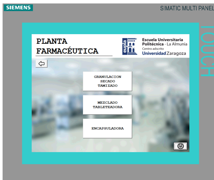
Ilustración 88. Selección procesos Nave 1 SCADA
