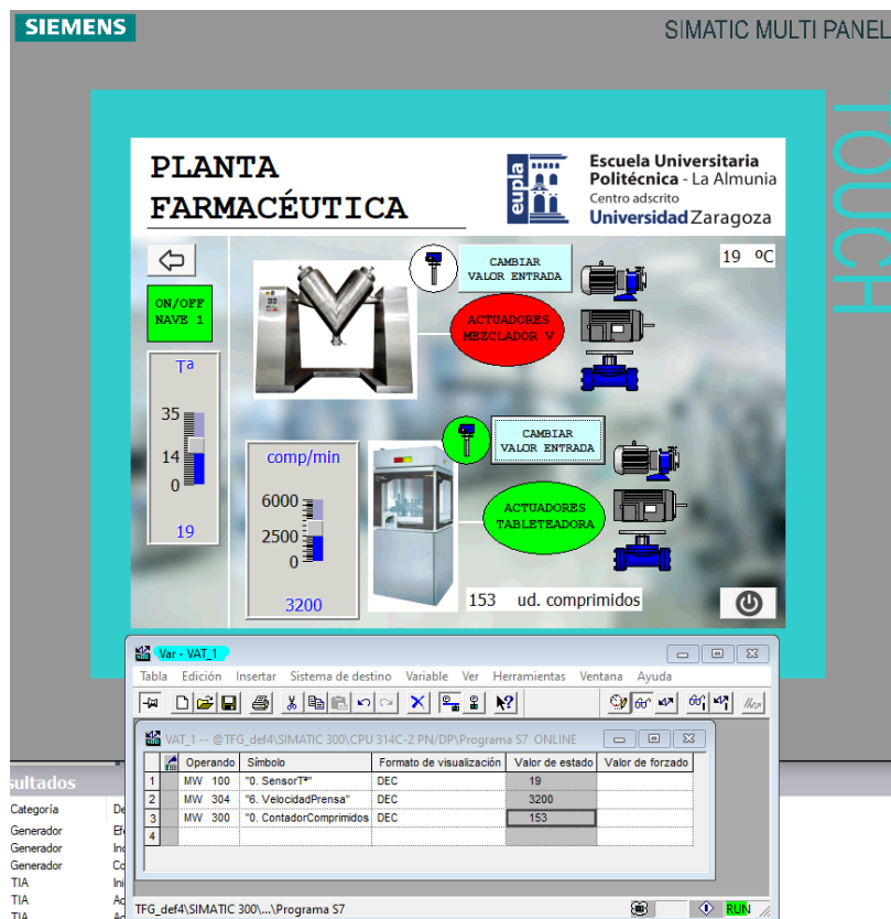
Ilustración 90. Control manual creación comprimidos Nave 1 SCADA
