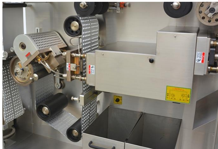
Ilustración 60. Estación de sellado rotativo (Jornen, 2018a)
