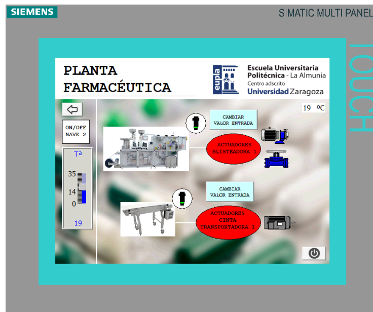
Ilustración 94. Acondicionamiento primario Nave 2 SCADA
