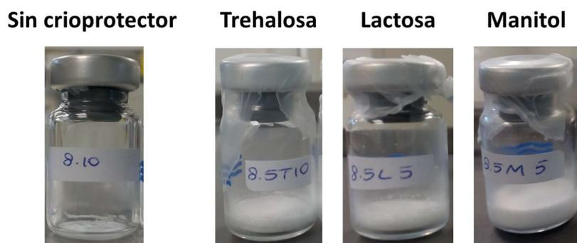
**Figura 5. Fotos de las tortas obtenidas tras liofilizar las NCs sin crioprotector o tras la adición de azúcares crioprotectores.**
