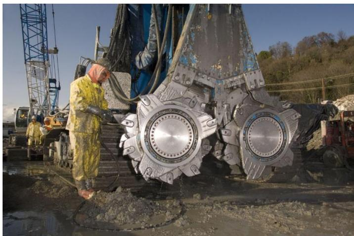
Figura 2-19 Cabeza cortadora o Hidrofresa (V́ctor Yepes Pisqueras, 2015)
