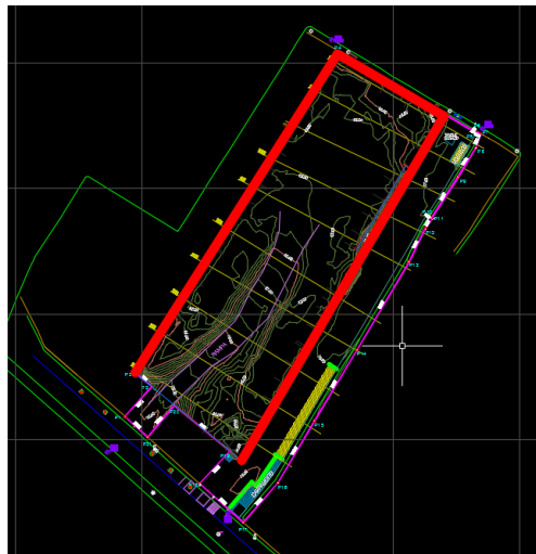
Figura 35. Ejecución de la Etapa I del proyecto (Muros Pantalla).
