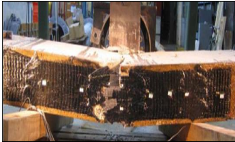
Figura 16: Ruptura de la Hoja de CFRP cuando se Usa el Ancla.
