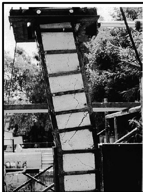
Figura 14: Patrón de Grietas del Espécimen de Pruebas.
