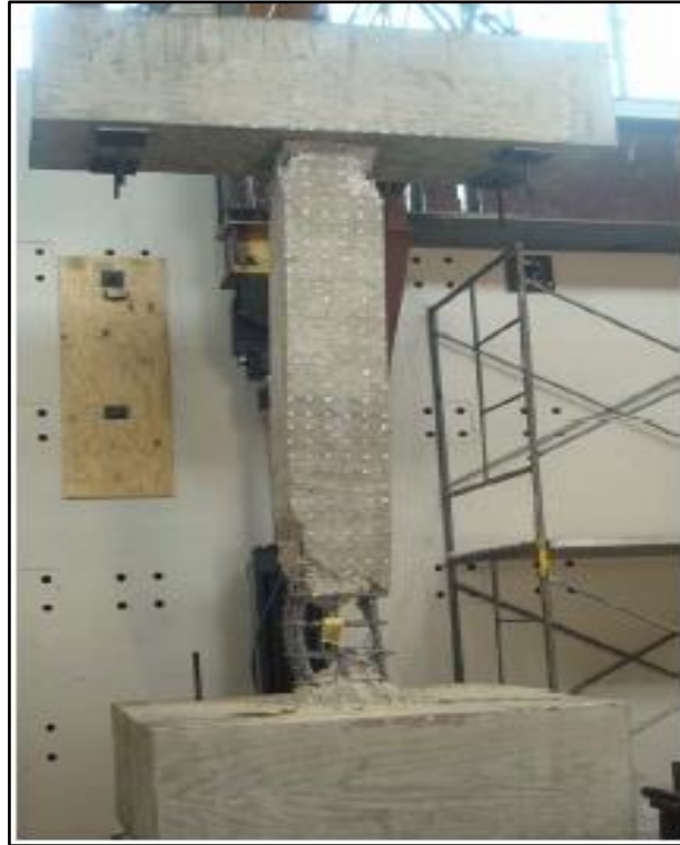
Figura 46: Condición de la columna antes del reforzamiento.
