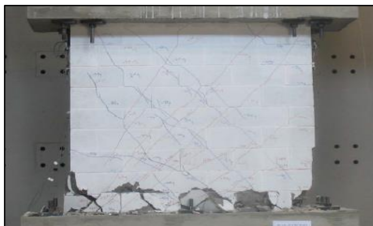
Figura 28: Aplastamiento de Muro de Mampostería al final de la Prueba.
