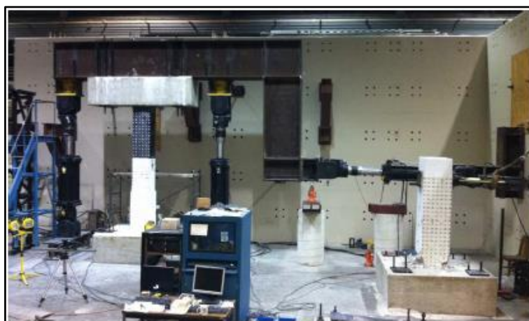
Figura 58: Configuración de Prueba para la Columna RC-1R.
