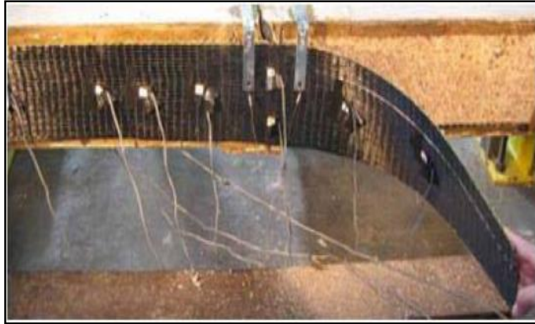
Figura 15: Desacoplamiento de la Hoja de CFRP Antes de que se Alcance la Resistencia de la Hoja.
