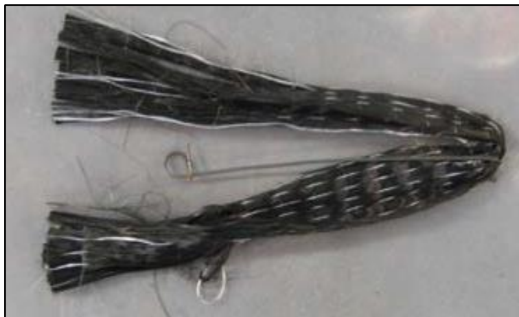
Figura 31: Anclaje CFRP antes de la Instalación.
