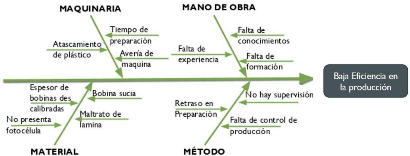
Figura 33. Diagrama causa y efecto de análisis Flexopack Perú. Elaboración propia.
