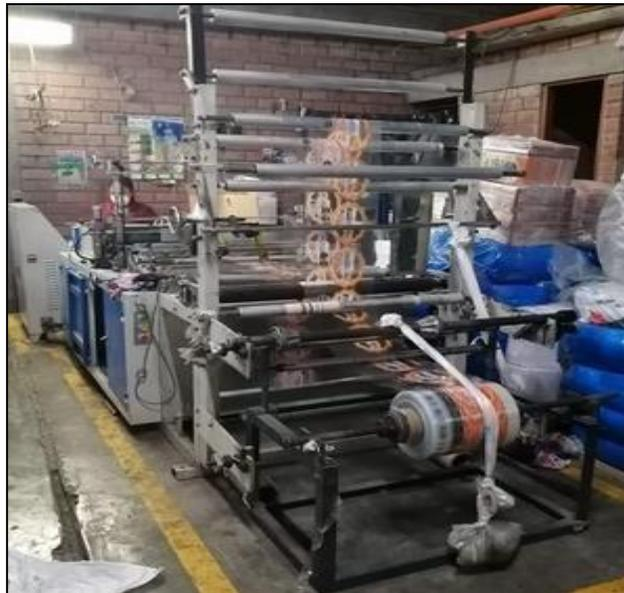
*Figura 25: Máquina Selladora y Cortadora*
