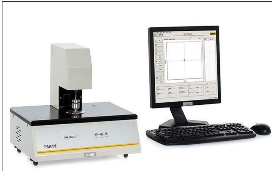
Figura 64. CHY – CB Medidor de espesor. Labthink
