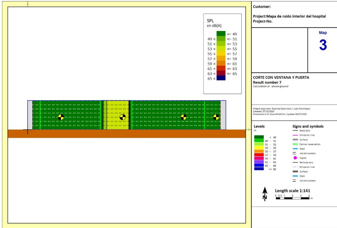
Figura 62: Sección longitudinal del mapa de ruido empleando ventanas de vidrio insulatedo y puertas contraplacadas en pasadizo de ingreso, vista de corte en el software SoundPLAN. Fuente: Elaboración propia.
