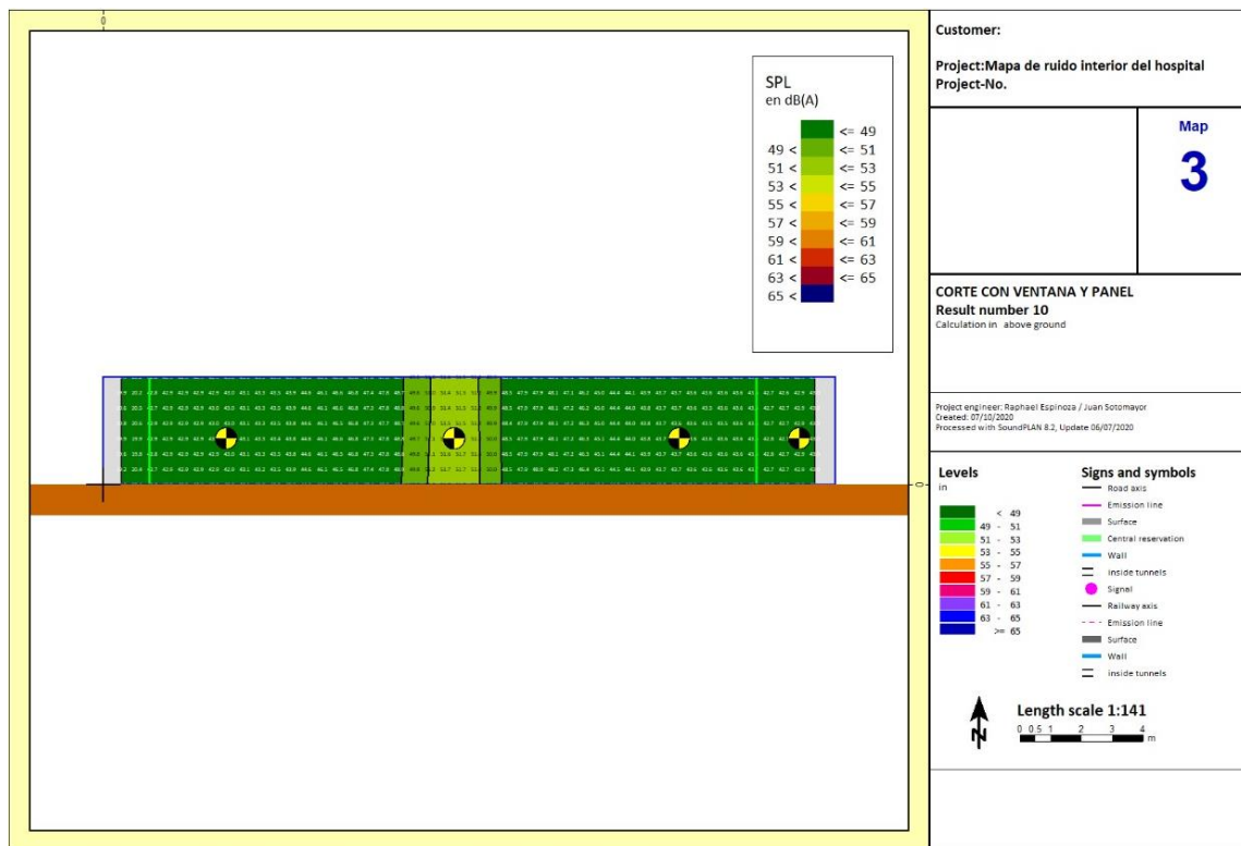
Figura 66: Sección longitudinal del mapa de ruido empleando ventanas de vidrio insulated y paneles de corcho en pasadizo de ingreso, vista de corte en el software SoundPLAN. Fuente: Elaboración propia.
