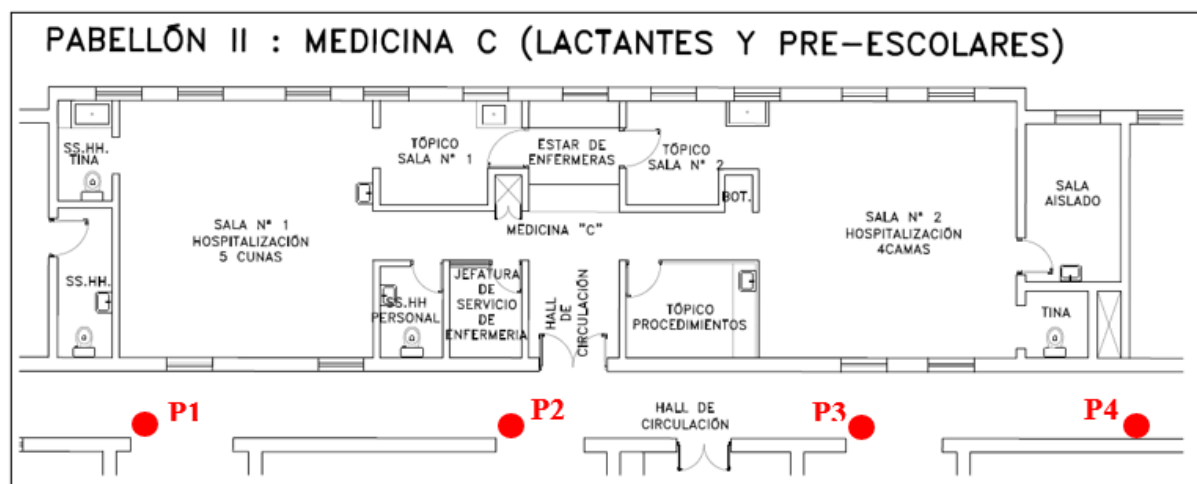
Figura 41: Puntos de medición de ruido en hall de circulación hospitalización del Instituto Nacional de Salud del Niño. Fuente: Elaboración propia.
