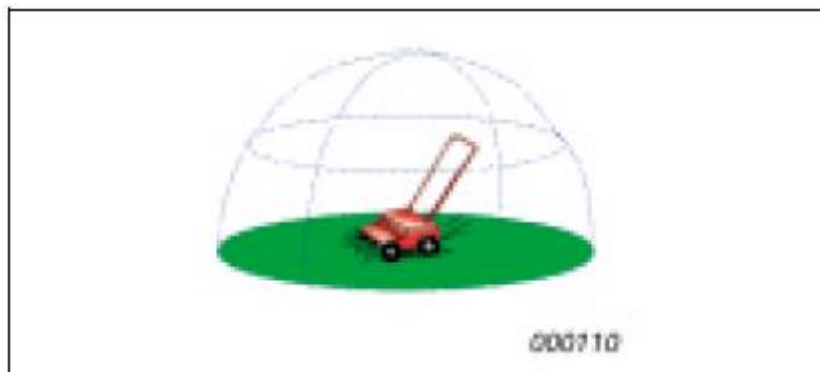
Figura 15: Fuente puntual. Fuente: Adaptado de Sound & Vibration Measurement A/S, por Brüel & Kjær, 2000
