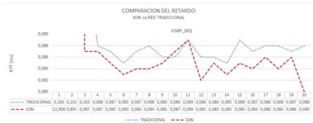
Figura 9.- Ejemplo de una comparación de retardo aplicando las buenas prácticas y siguiendo lineamientos de los fabricantes (SDN vs Red Tradicional).
