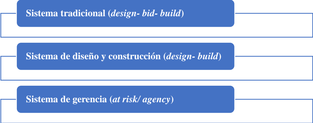
Figura 19. Project delivery system más utilizados en la industria
