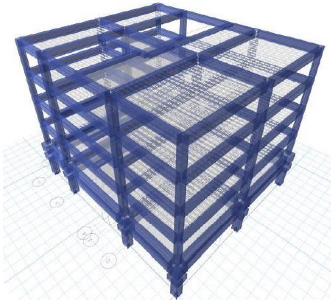
Figura 55: Vista Tridimensional del Modelo Matemático en ETABS V.16.2.0
