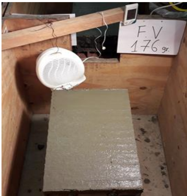
Figura 14 Concreto vaciado en Molde metálico con 175 gr de fibra virgen
