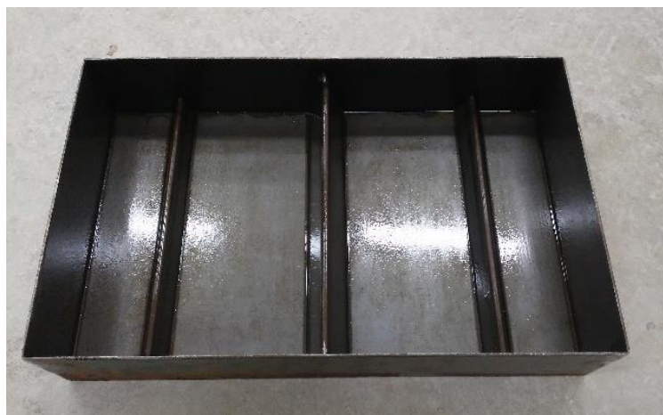
Figura 6 Molde Metálico según norma ASTM C 1579
