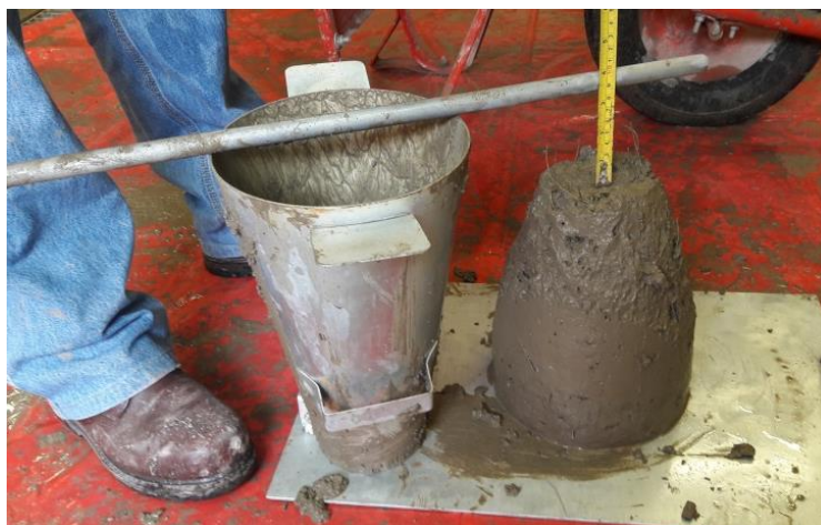
Figura 19 Slump de 3 \frac{1}{2}'' con Fibras Reciclada 116 gr
