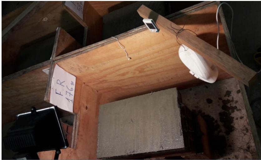
Figura 23 Vaciado concreto con 176 gr de fibras recicladas
