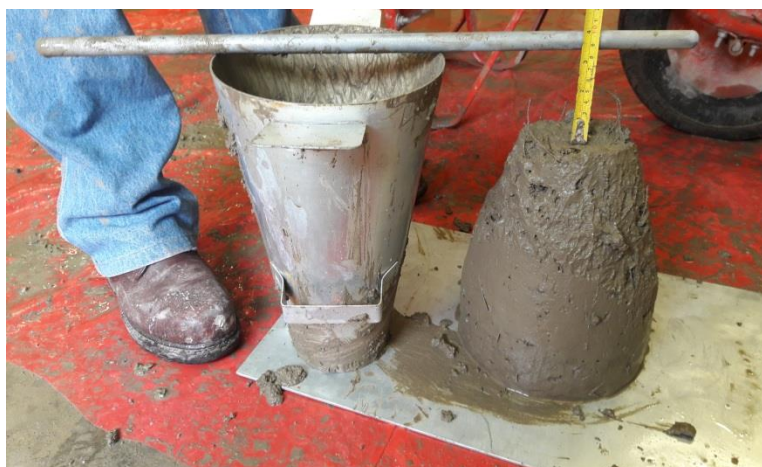
Figura 10 Slump de 3 \frac{1}{2} " con Fibras Virgen 116 gr
