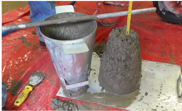
Figura 22 Slump de 3 \frac{1}{2}'' con 176 gr Fibras Recicladas
