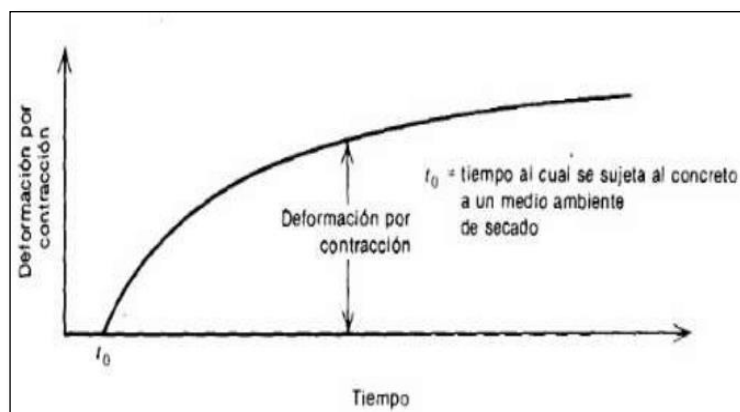
Figura 3 Gráfico deformación del concreto/ tiempo
