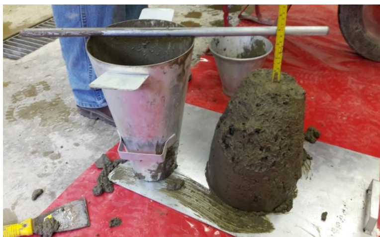
Figura 7 Slump de 3 1/2” Diseño Patrón
