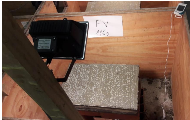
Figura 11 Concreto vaciado en Molde metálico con 116 gr de fibra virgen
