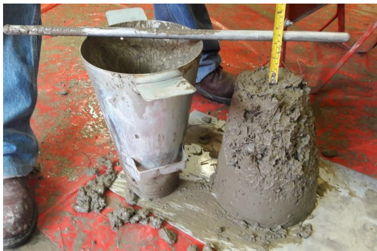
Figura 16 Slump de 3" con 58 gr Fibras Reciclada
