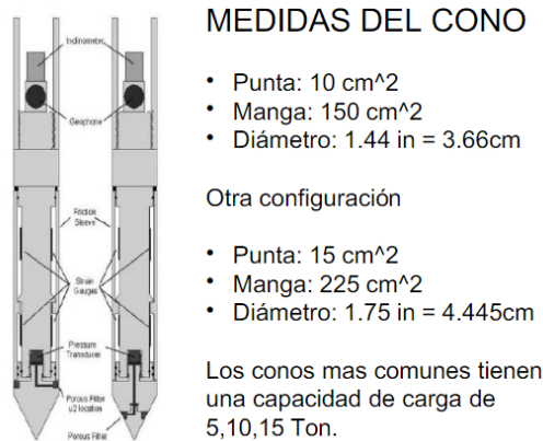
Figura 27: Cono del ensayo CPT (Gonzales 2005)
