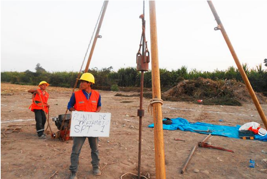
Figura 12: Ensayo de campo SPT (Erkom Peru 2009)
