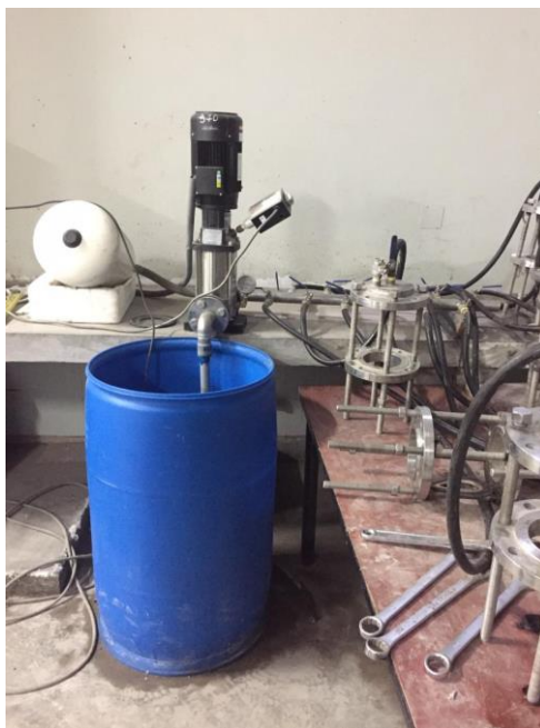
Figura 19. Ensayo de Densidad, absorción y vacíos en el concreto endurecido Adaptado de Laboratorio UNI
