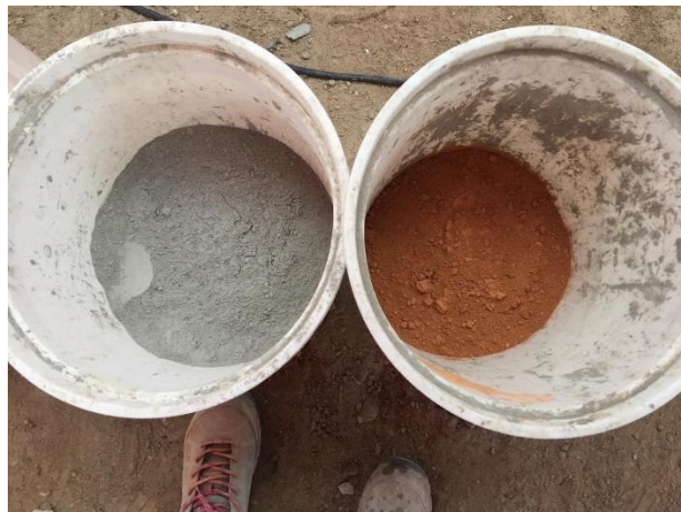
Imagen 8. Baldes con contenido de cemento y polvo de ladrillo de arcilla Fuente propia
