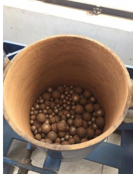
Figura 14. Bolas de acero en el recipiente de la máquina de Molino de Bola Adaptación propia, Fábrica de Metasil
