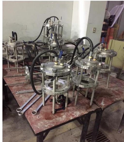
Figura 21. Equipo de permeabilidad bajo presión de agua Adaptado de Laboratorio UNI
