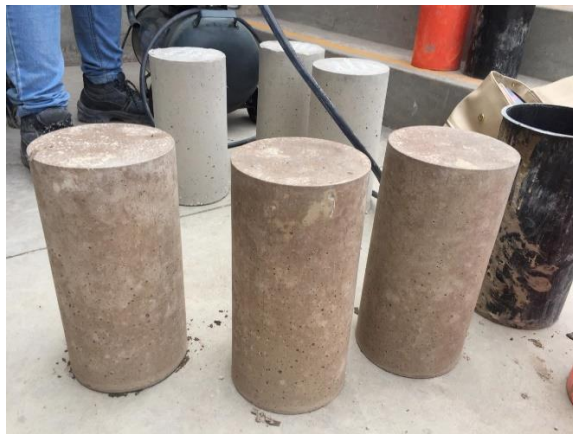
Imagen 12. Desmoldado de Probetas para curar Fuente propia
