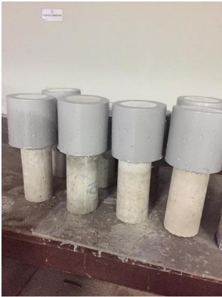
Figura 20. Probetas cortadas con la aplicación de barniz Adaptado de Laboratorio UNI
