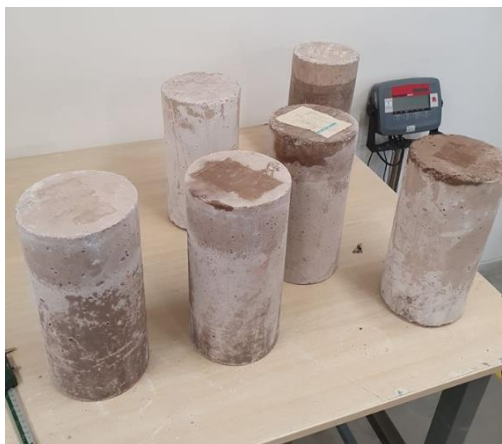
Imagen 13. Probetas a ensayar por resistencia a la compresión Fuente propia
