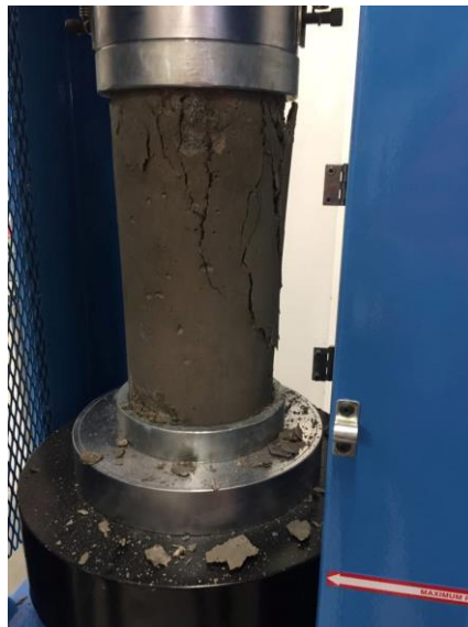
Figura 30. Rotura de probetas a los 7 días de curado Adaptación propia
