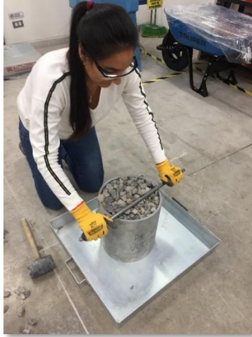
Imagen 3. Compactado de Agregado grueso Fuente propia
