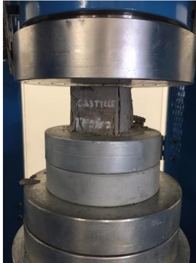
Figura 23. Rotura de cubos de mortero para el ensayo de índice de Actividad Puzolánica Adaptación propia
