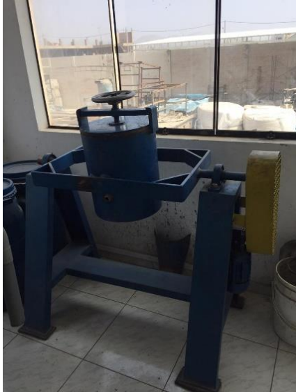
Figura 13. Molino de Bola 14"x17" Adaptación propia, Fábrica de Metasil
