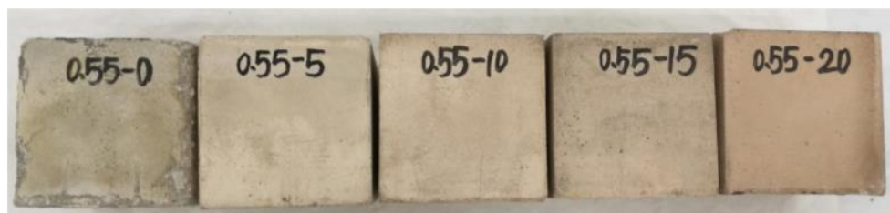
Figura 8. Imagen de los especimenes con ataque a los sulfatos
