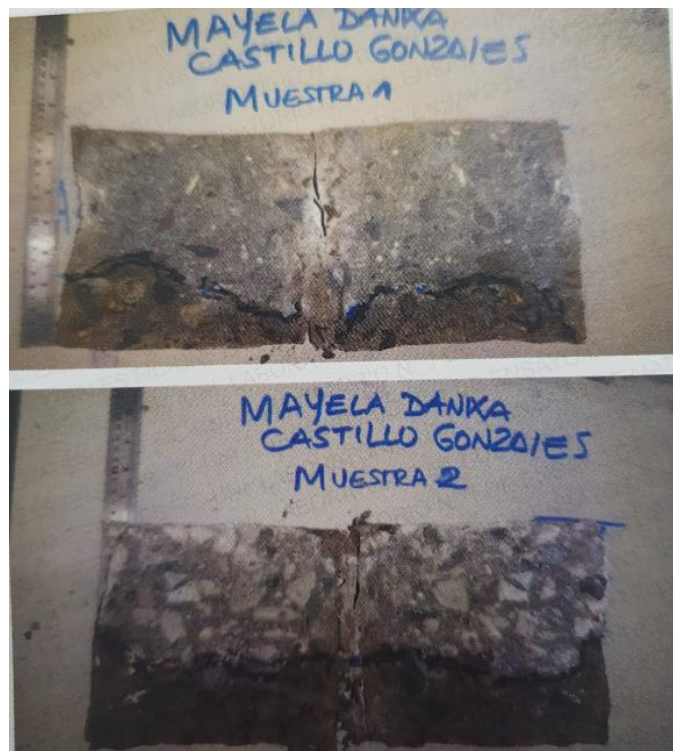
Figura 32. Muestras partidas diametralmente para medir la profundidad de penetración Adaptación de Laboratorio Uni
