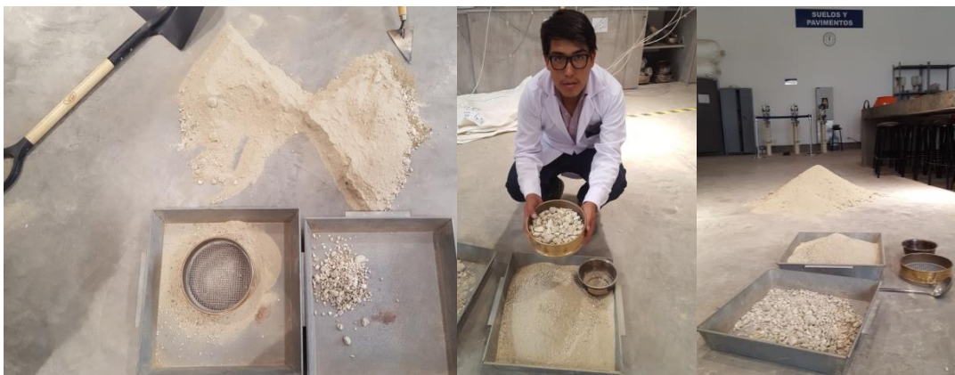
Figura 43. Proceso realizado para separar el material fino del grueso usando la malla N°4, por fuente propia, 2018.
