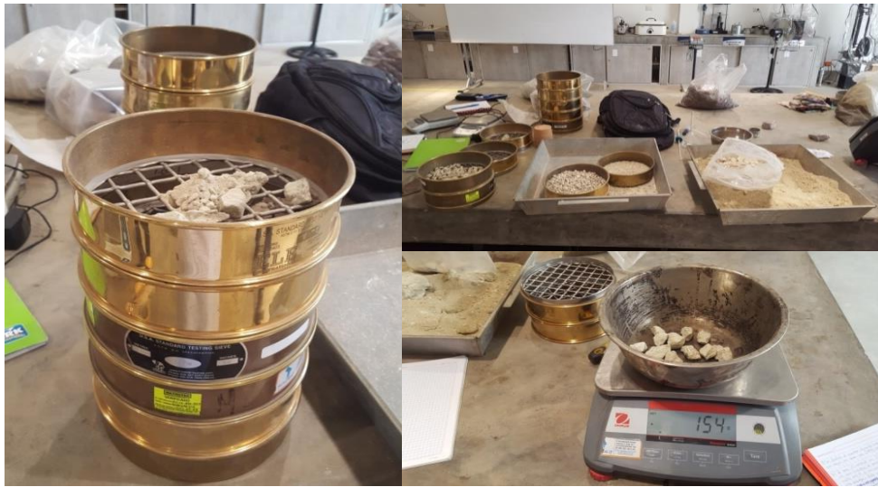
Figura 44. Proceso de tamizado para el material grueso, por fuente propia, 2018.
