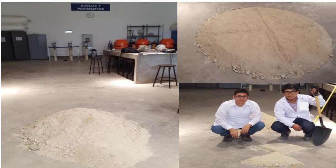
Figura 42. Proceso para realizar la técnica del cuarteo, por fuente propia, 2018.
