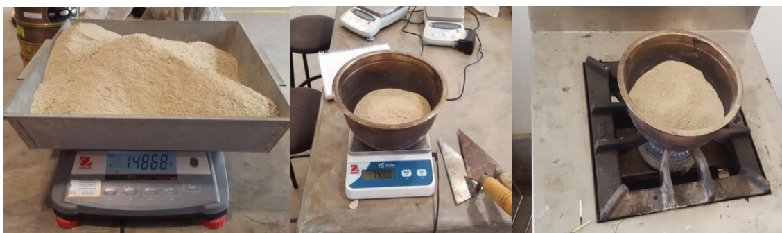
Figura 38. Proceso a realizar para toma de datos y cálculo de la humedad natural del suelo, por fuente propia, 2018.
