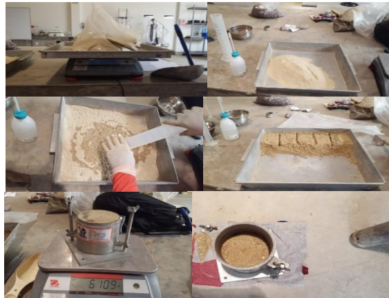
Figura 51. Proceso de preparación del espécimen a compactar a una determinada humedad, por fuente propia, 2018.
