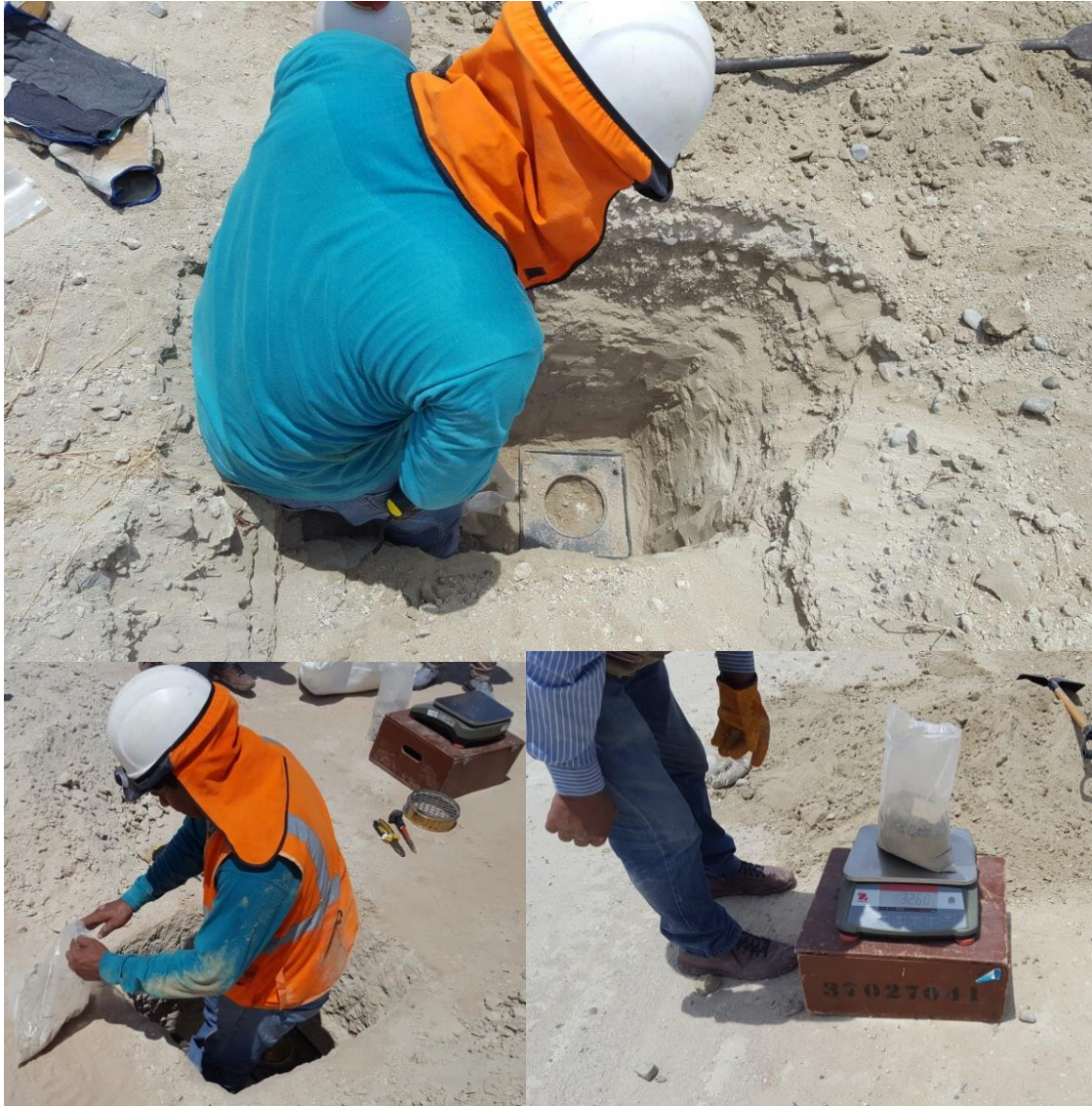
Figura 35. Extracción y pesaje del material dentro del círculo hueco en bolsas plásticas, por fuente propia, 2018.
