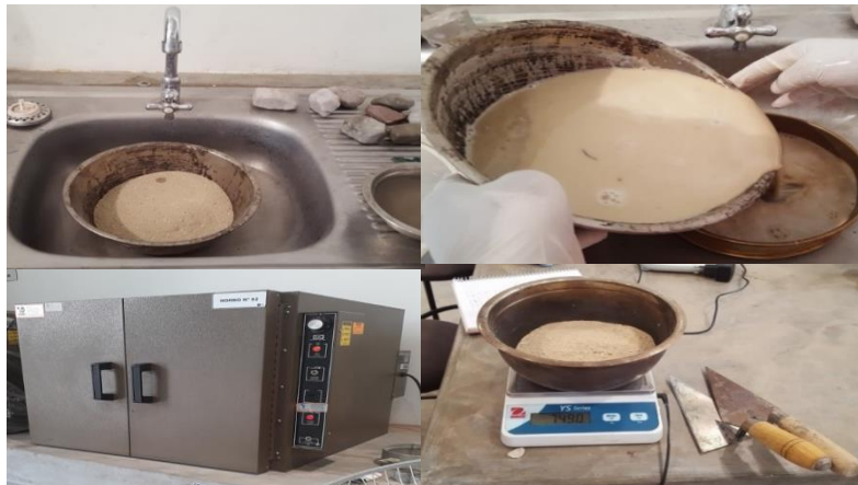
Figura 45. Proceso para hallar el % de finos del suelo, por fuente propia, 2018.
