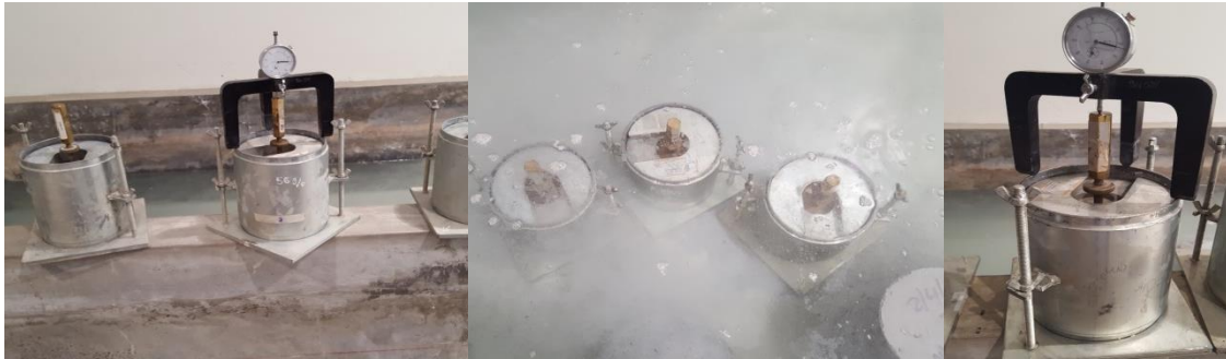
Figura 56. Proceso seguido antes, durante y después de medir el hinchamiento de la muestra, por fuente propia, 2018.
