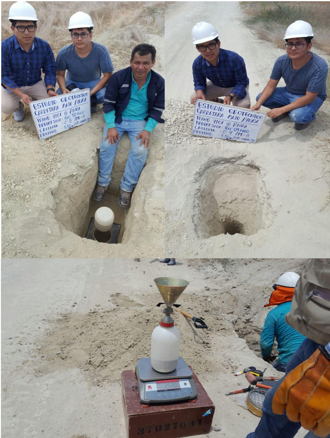
Figura 36. Se observa el proceso para determinar la densidad natural del suelo del Bajo Piura, por fuente propia, 2018.
