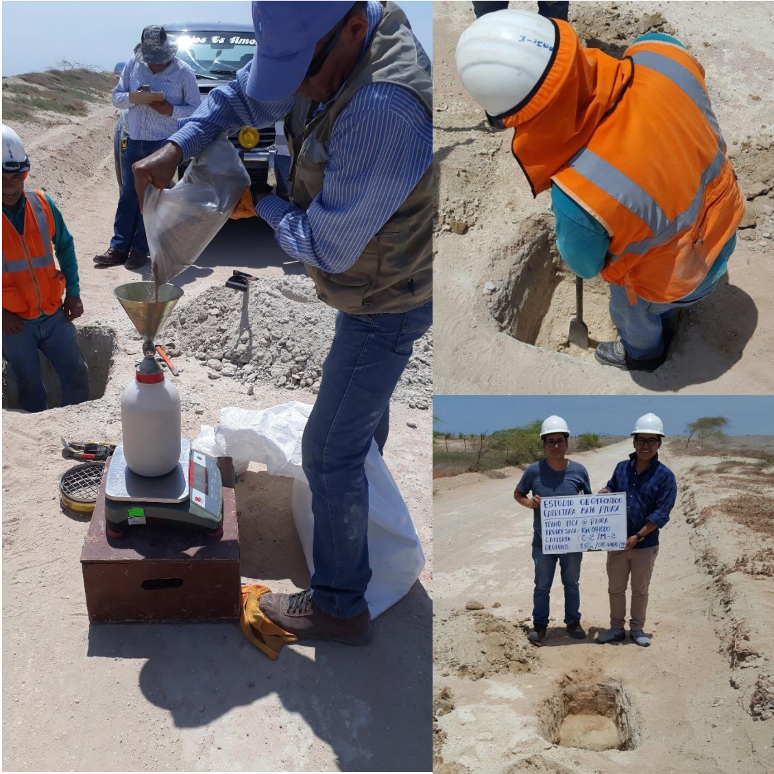
Figura 34. Pesado de la arena y perfilado de la superficie, por fuente propia, 2018.
