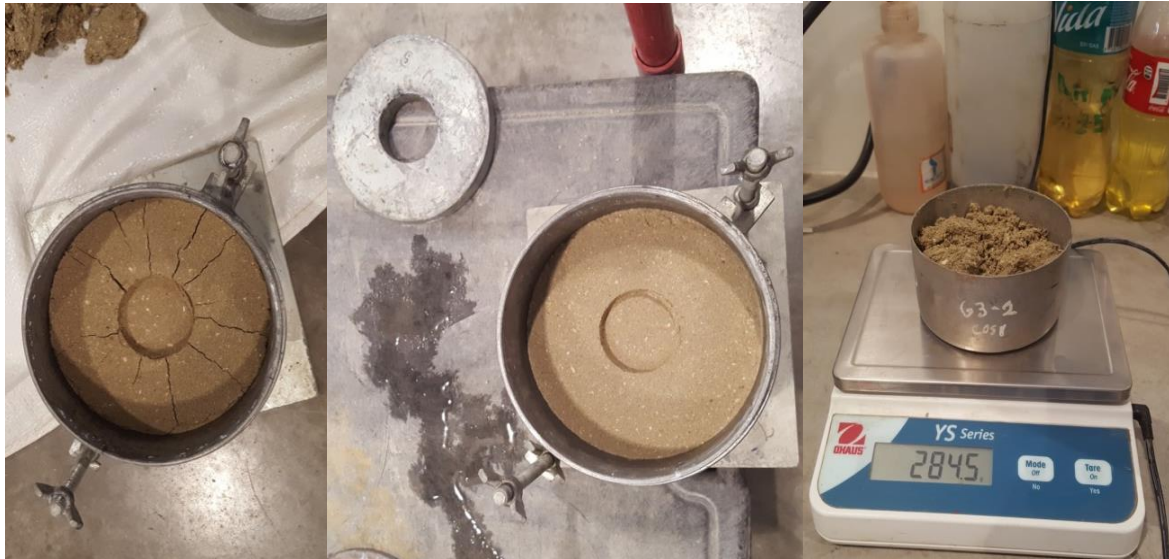
Figura 58. Suelo fisurado a 12 golpes/capa y a 56 golpes/capa y la toma de suelo para la hallar la humedad final, por fuente propia, 2018.
