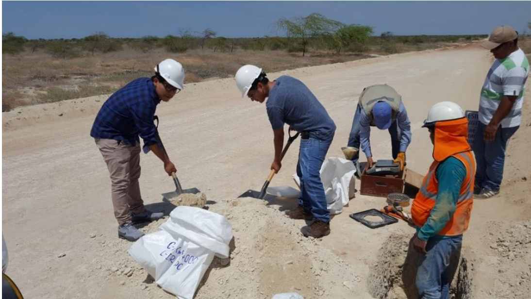
Figura 37. Toma de muestras de suelo representativo que será ensayado en laboratorio, por fuente propia, 2018.
