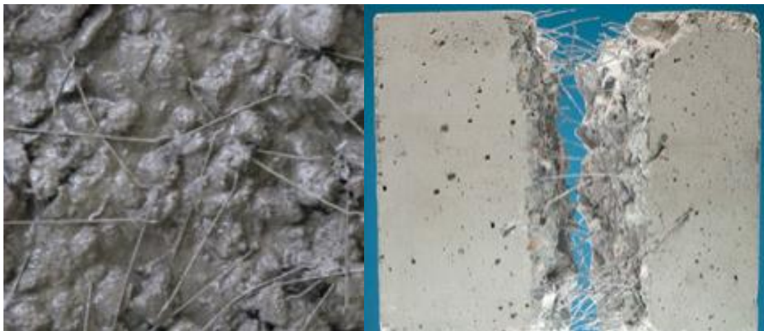
Figura 7. Concreto fresco y concreto endurecido de un pavimento reforzado con fibras, por Collazos, 2012.
