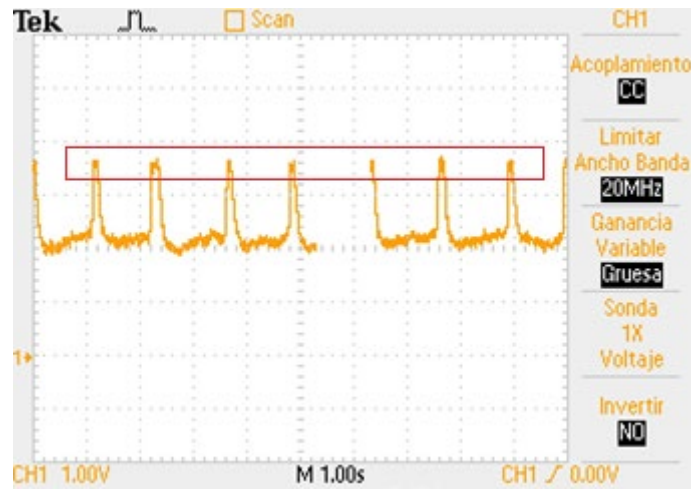
Figura 47. Pruebas de parpadeo con una ganancia total de 5000 y offset de 2V. Elaboración propia.
