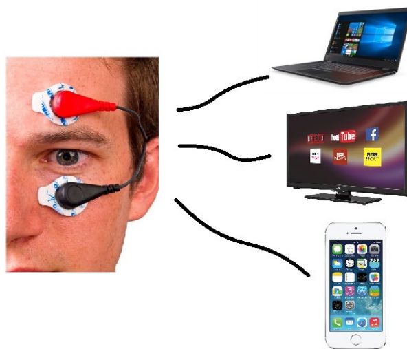
Figura 5. Uso de las señales EOG para el control de dispositivos electrónicos. Elaboración propia.
