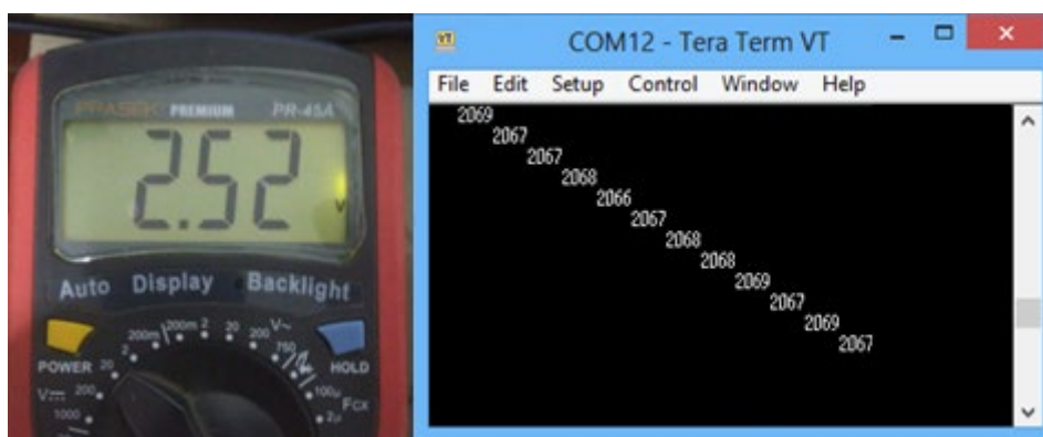
Figura 102. Voltaje de entrada a digitalizar (izquierda) y valores cuantizados por el dsPIC30F3013 (derecha). Elaboración propia.
