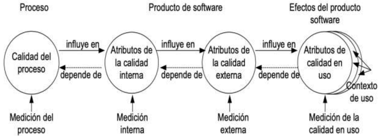
Figura 12. Marco conceptual para el modelo de calidad. Adaptado de “ISO/IEC SQuaRE. The second generation of standards for software product quality”, por Abran et al., 2003.
