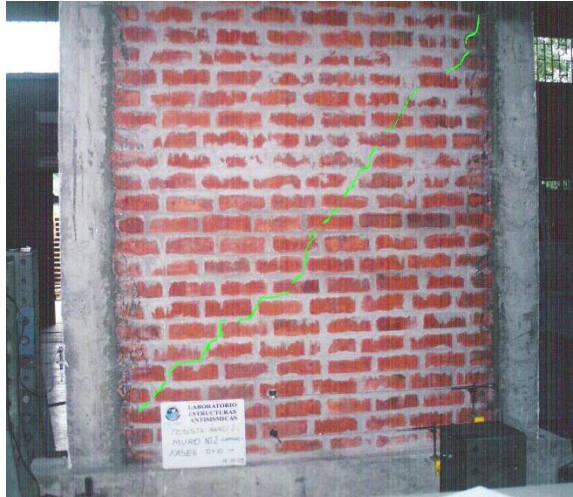
Figura 18. Grietas generadas por la fase 6 (D=10.0mm)
