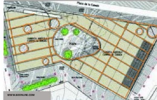
En el techo se dispuso poner un parque, el cual requiere una losa especial que permita el drenaje del agua, el aislamiento total de la superficie para poder plantar árboles.
