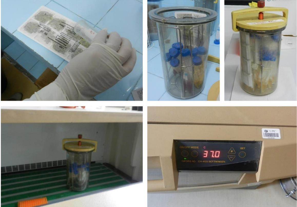
2. Preparación del Anaerocult (35 mL de agua destilada), armado de jarra para anaerobiosis y colocación de jarra con tubos de cultivo en incubadora (37°C)
