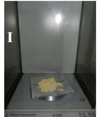
1. Pesar el medio de cultivo: G y H-Depreciación del peso del papel, I y J- Pesar cantidad indicada por el fabricante para el volumen final deseado del medio sólido BHI y transportar a la botella estéril autoclavable.
