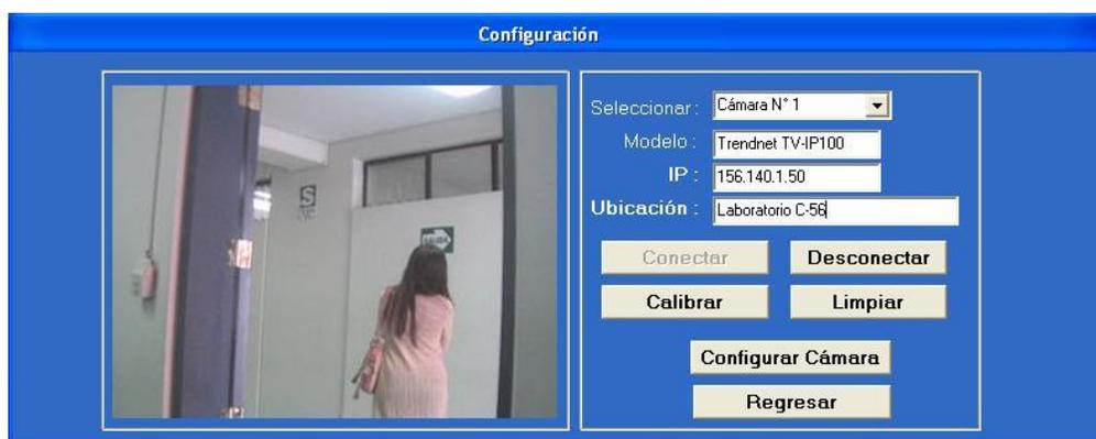
**Figura 4.3** Ventana de configuración de cámara IP. Esta ventana de configuración también posee otros botones como *Desconectar*, el cual desconecta la cámara IP visualizada. También
