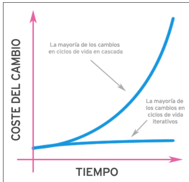
Figura 1.8 - Línea de costo de cambio en el tiempo para ciclos de vida iterativo y en cascada
