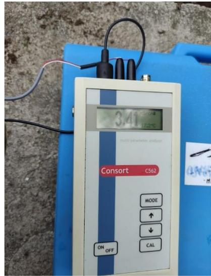
Imagen 1. Mediciones de caudal con método de trazadores con inyección
