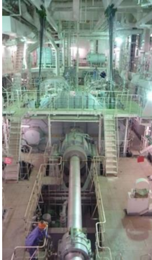
Ilustración 44: Reductora junto con la turbina. Fuente: Mitsubishi Heavy Industries.
