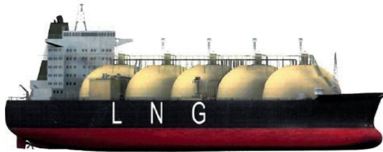
Ilustración 9: Buque LNG con sistema Moss. Fuente: Seamanship Publication.
