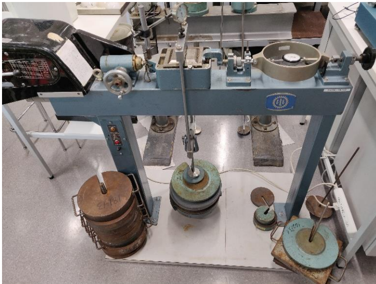
Kuva 10. Rasialeikkauskoje Oulun yliopiston geotekniikan laboratoriossa.
