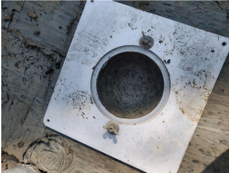
Kuva 9. Ilmavolymetrin pohjalevy ja tehty kuoppa.
