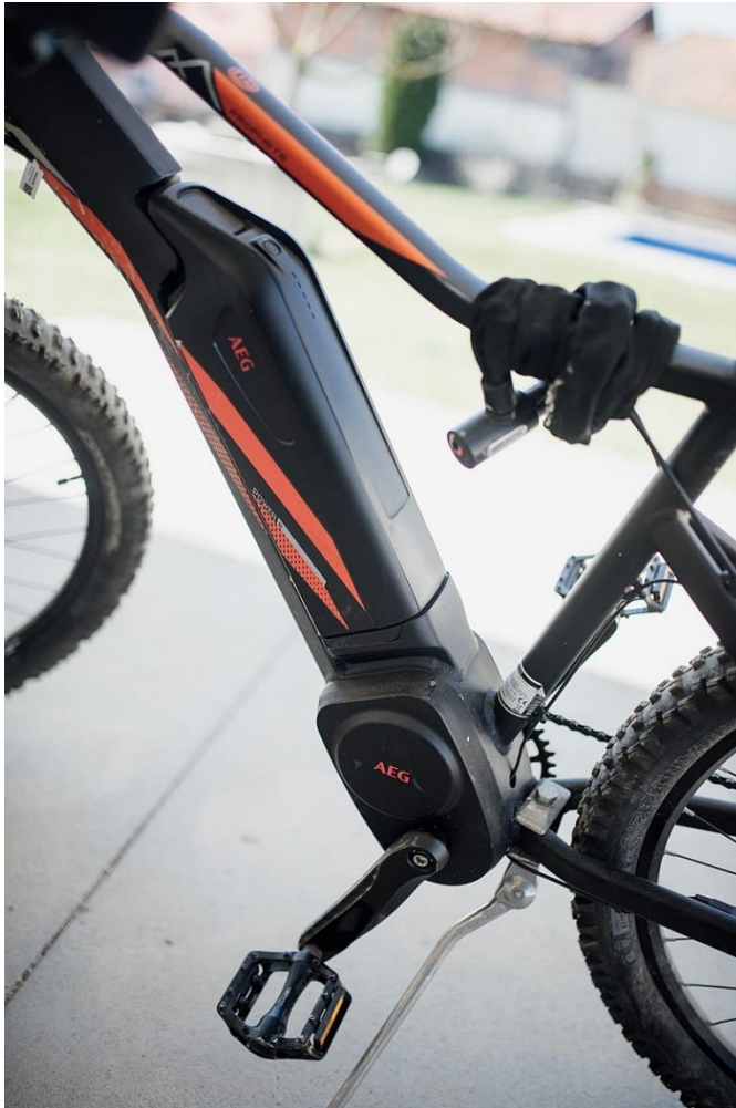
Kuva 8. AEG SportDrive-keskiömoottori ja runkoon integroitu akun kiinnitys (Wikimedia Commons 2022, vapaa materiaalipankki).
