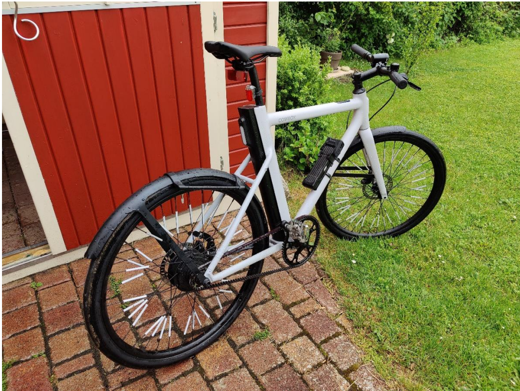
Kuva 7. Napamoottori polkupyörän takarenkaan navassa (Wikimedia Commons 2019, vapaa materiaalipankki).
