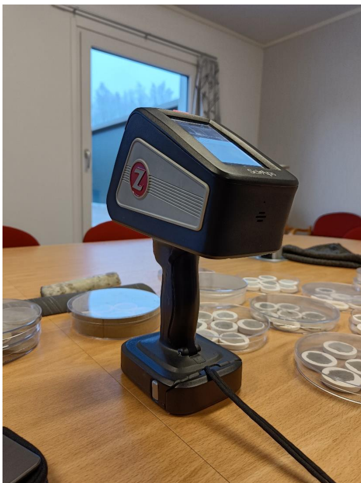
Kuva 11. pLIBS-analysaattori SciAps Z-300 ja näytenappeja. Näpät on analysoitu Keliber Oyn toimistolla, Kaustisilla. Kuva Aleks Huttunen, 2022.
