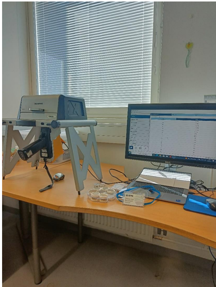
Kuva 7. XRF-laite Olympus Vanta M-Series ja mittausasema. GTK, Kuopio. Kuva Aleks Huttunen.
