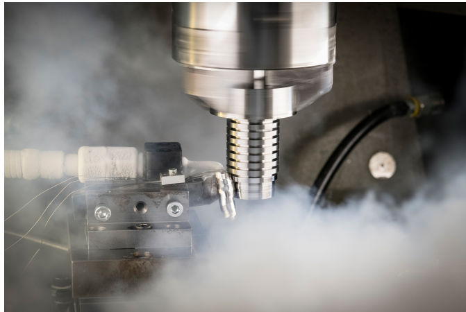
Abbildung 1.2.: Momentaufnahme der kryogenen Zerspanung einer genuteten Welle [9]
