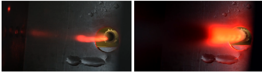
(a) Strömung besteht aus nahezu reinem \text{GN}_2 , da (b) Strömung beinhaltet \text{LN}_2 , da Reflektionen des einfallenden Lichts.
