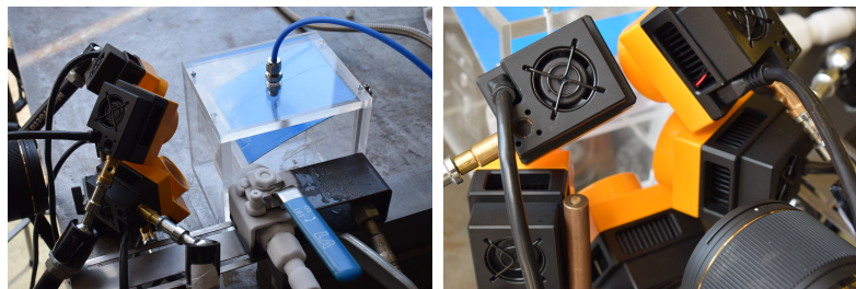
Abbildung 3.8.: Fotoaufnahme der ringförmigen Anordnung der G-S-8 Köpfe, um eine einheitliche Ausleuchtung des untersuchten Kanals zu ermöglichen
