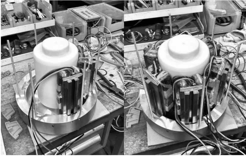
Abbildung 4.4: Zusammenbau des SRM mit der Montage der einzelnen U -Elemente um eine Zentrierhilfe.
