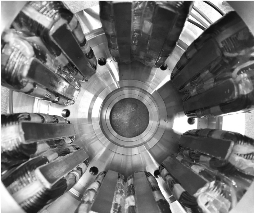
Abbildung 4.5: Blick in das Innere des Motors. Der Rotor ist entfernt und es sind nur die Statorelemente sowie die Schenkelenden der U -Elemente zu sehen.
