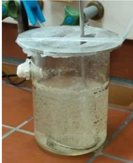
Abbildung 16: Batchreaktor (0,8 L) zur Untersuchung von Abwasserpartikeln als mittelfristige Nährstoffquelle.
