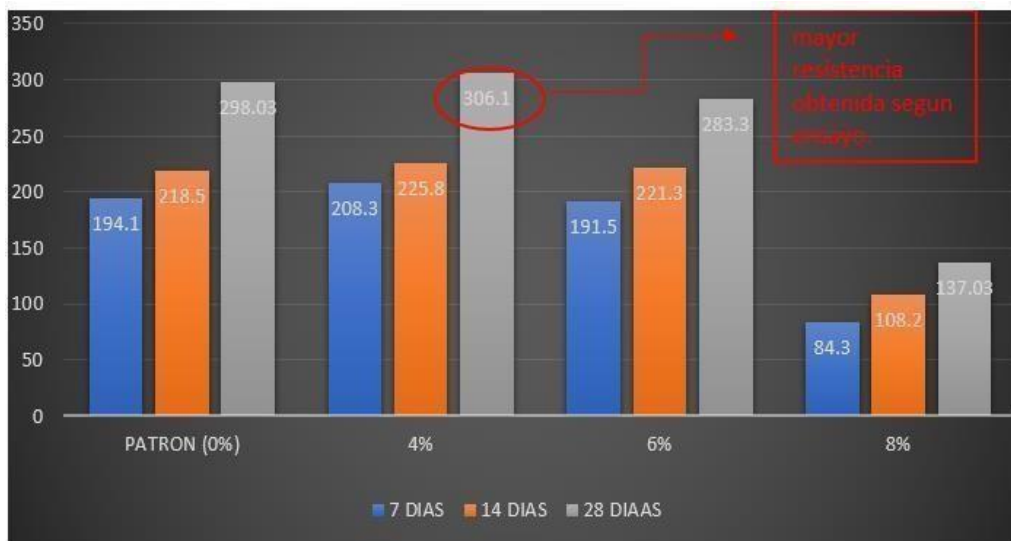
FIGURA 2: promedios de resistencia a la compresión obtenida del concreto patrón, así como también del grupo experimental con adiciones del 4% 6% y 8% de cuescode palma aceitera a la mezcla.
