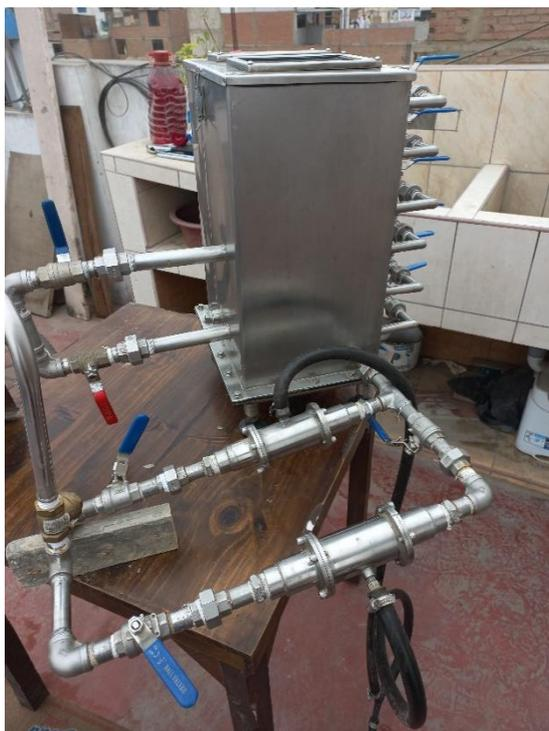
Figura N° 10: Equipo de Micronanoburbujas
