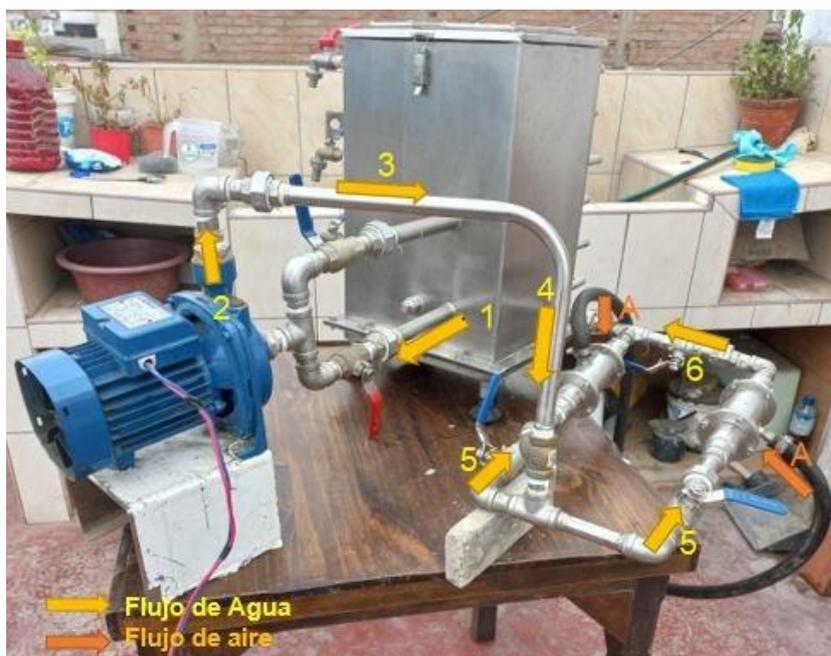
*Figura N° 5: Sistema de tratamiento con micronanoburbujas*
