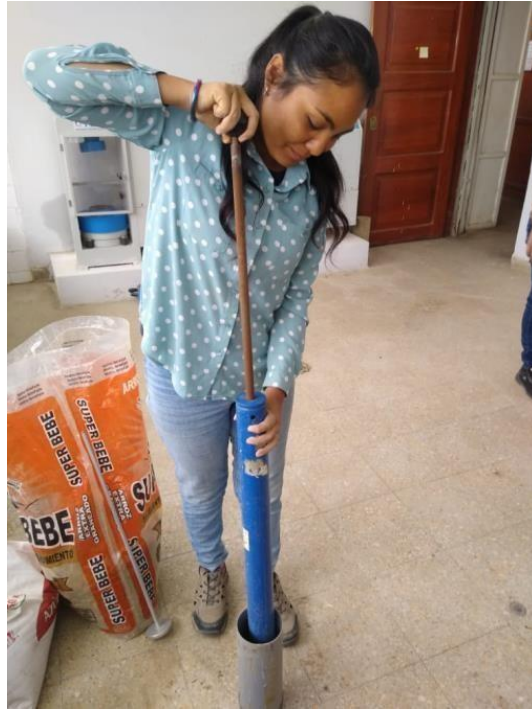
Figura 52: Se procede a realizar los golpes por cada capa Fuente: Elaboración propia
