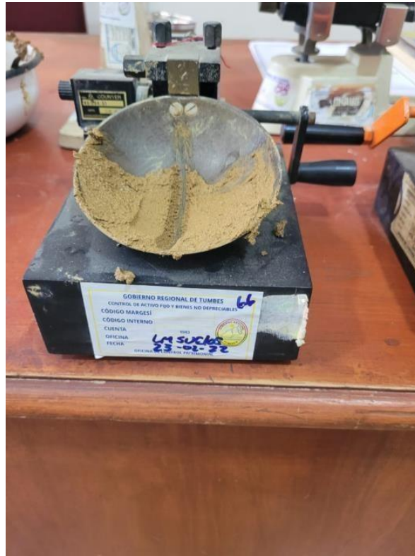
Figura 31: Se procede a realizar el ensayo de Casagrande para determinar limite líquido
