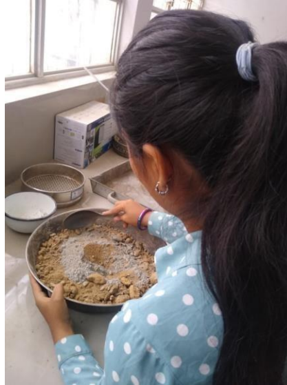
Figura 50: Se procede a realizar una mezcla homogénea de muestra cemento y agua Fuente: Elaboración propia
