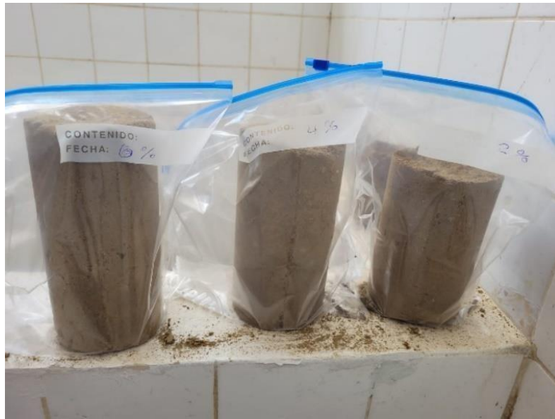
Figura 54: Se coloca las muestras en una bolsa hermética para evitar la pérdida de humedad Fuente: Elaboración propia
