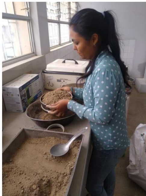
Figura 26: Tamizado de la muestra por maya 40 suelo con cemento 2%
