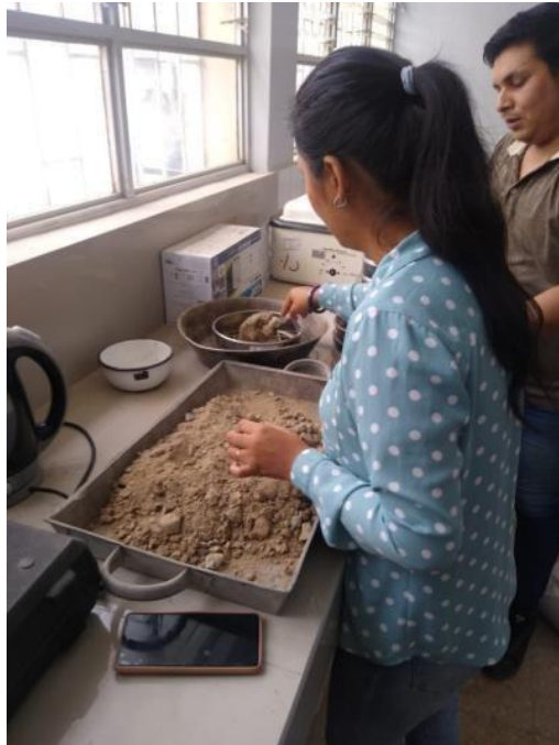
Figura 30: Tamizado de la muestra por maya 40 suelo con cemento 2%
