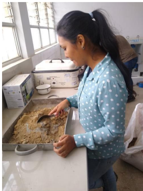
Figura 35: Se procede a mezclar uniformemente la muestra con cemento Fuente: Elaboración propia
