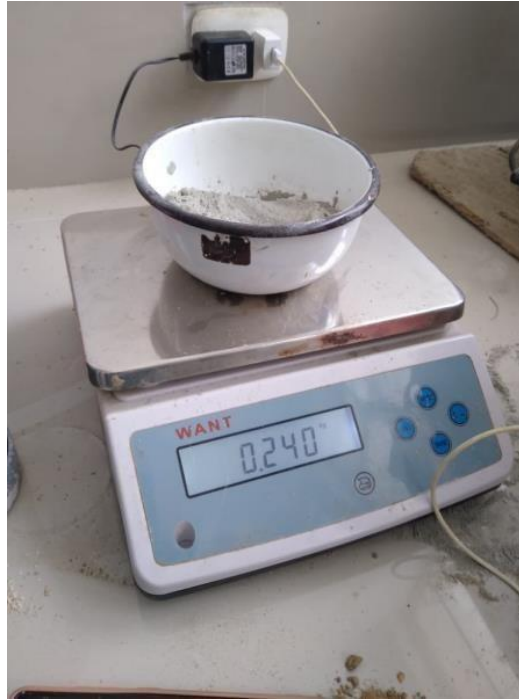
Figura 42: Se pesa el cemento según la deificación requerida
