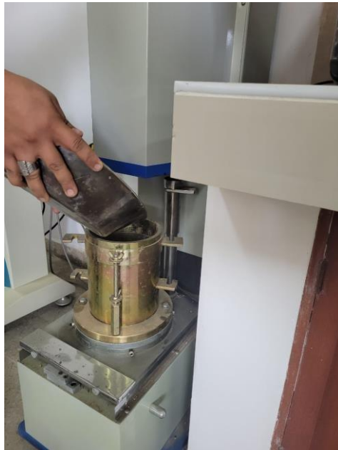
Figura 37: Se procede incorporar la mezcla al molde para proceder a 56 goldes Fuente: Elaboración propia
