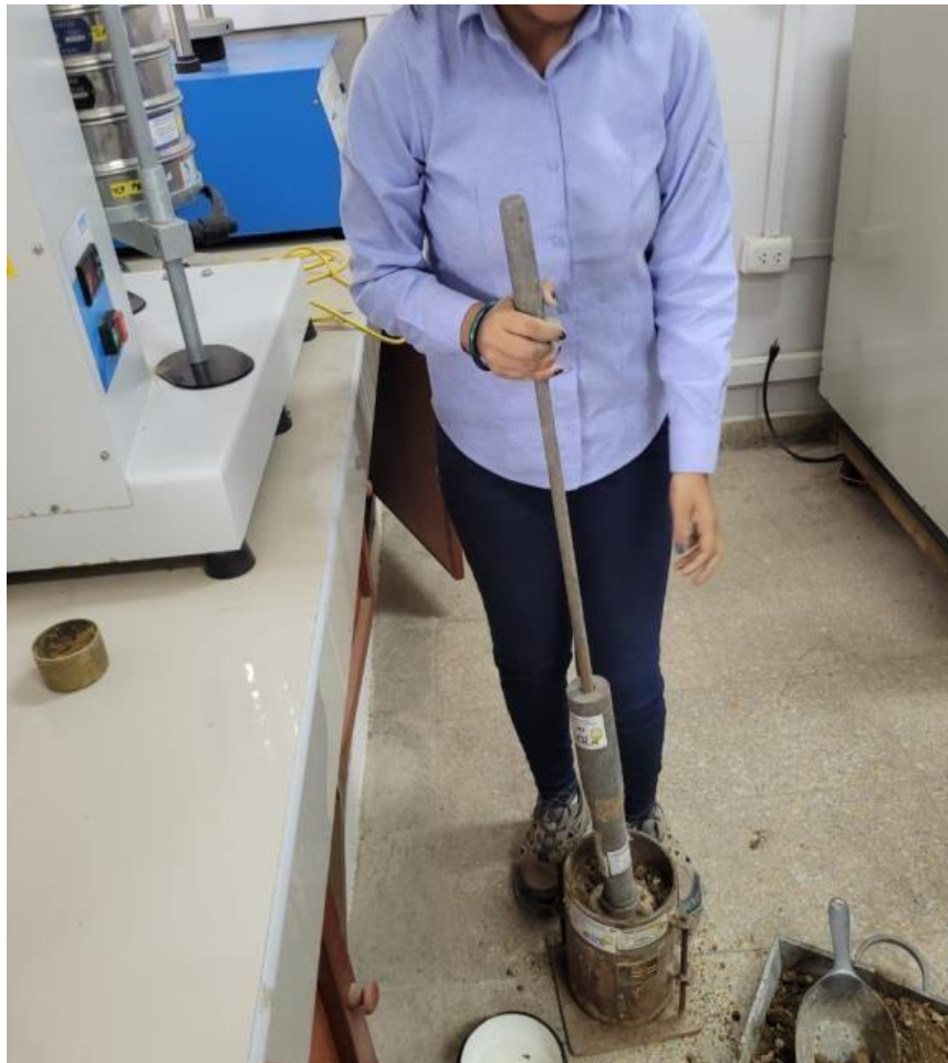
Figura 23: Realizando 56 golpes en tres capas del Suelo Natural
