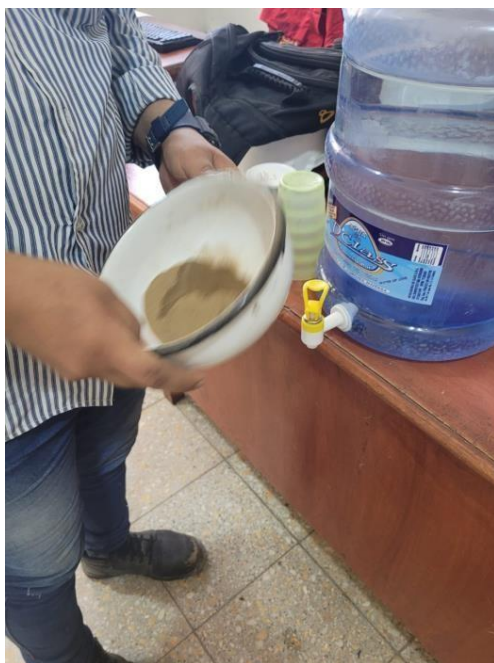
Figura14: Se satura de agua hasta obtener una mezcla homogénea
