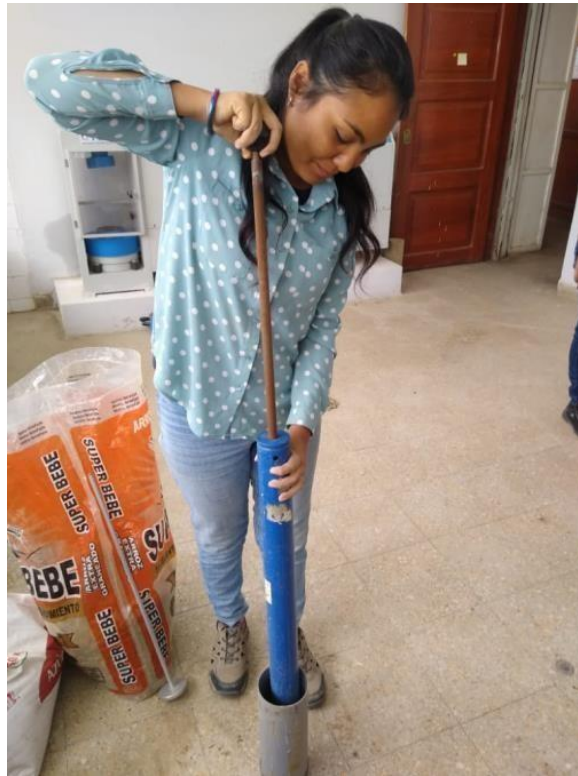
Figura 46: Se llenan el molde se procede a dar los 56 golpes
