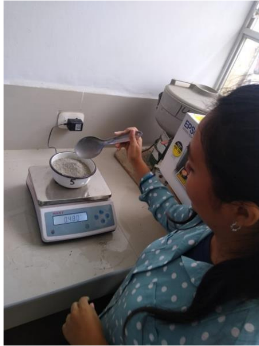
Figura 29: Pesando el cemento para la dosificación 2% de cemento
