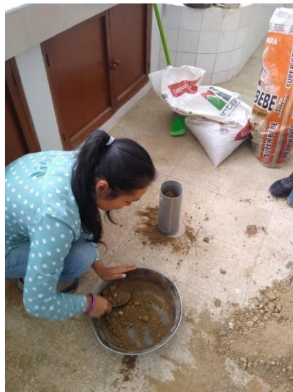
Figura 51: Se llenan los moldes con la mezcla en tres capas Fuente: Elaboración propi
