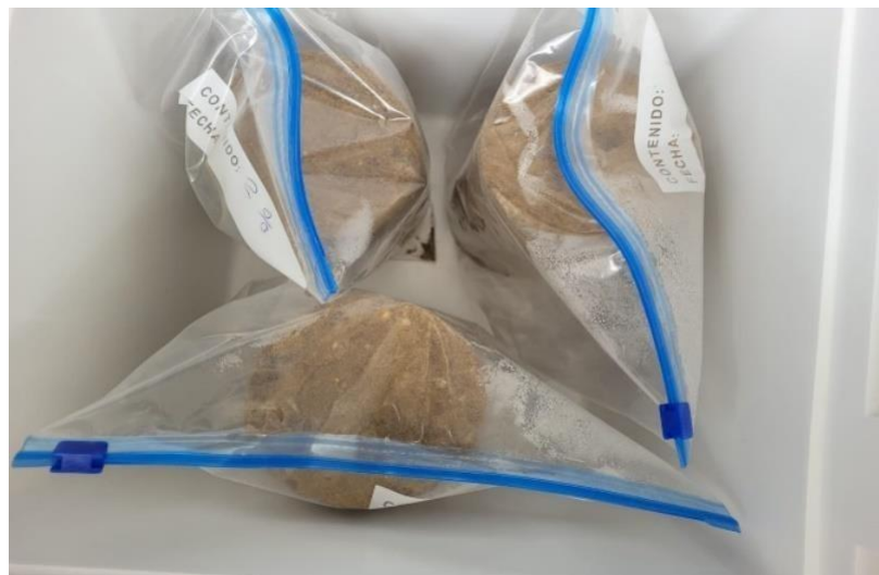
Figura 55: Se coloca en una cámara de humedecimiento por 5 horas sellada herméticamente se observa que la bolsa exsuda después de ese tiempo se pesa y mide la muestra Fuente: Elaboración propia
