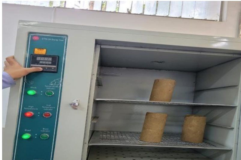
Figura 56: Se coloca la muestra en el horno por 48 horas se pesa y se mide las probetas
