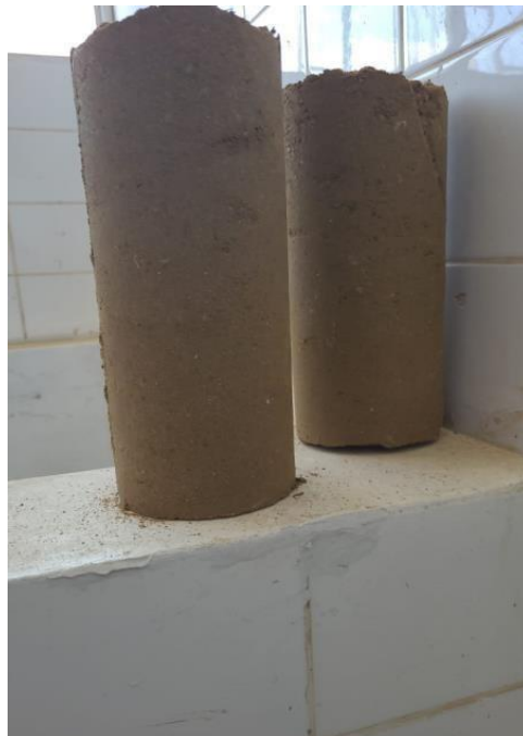
Figura 53: Después de 24 horas se procede a desmoldar Fuente: Elaboración propia
