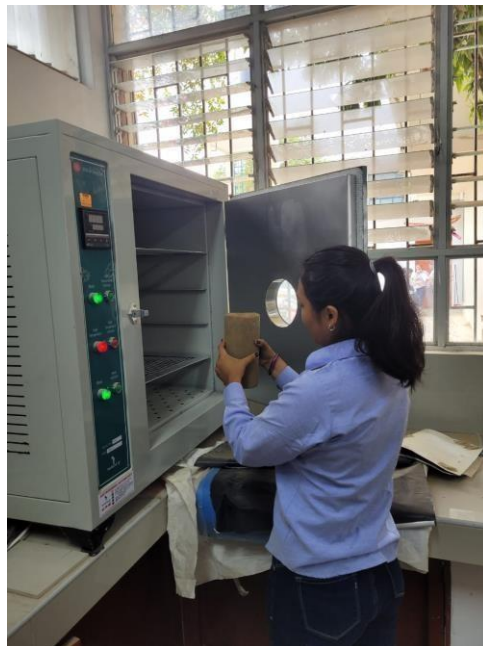
Figura 61: Se procede a colocar las probetas en el horno por 48 horas a 71°C se pesa y se mide otra vez Fuente: Elaboración propia
