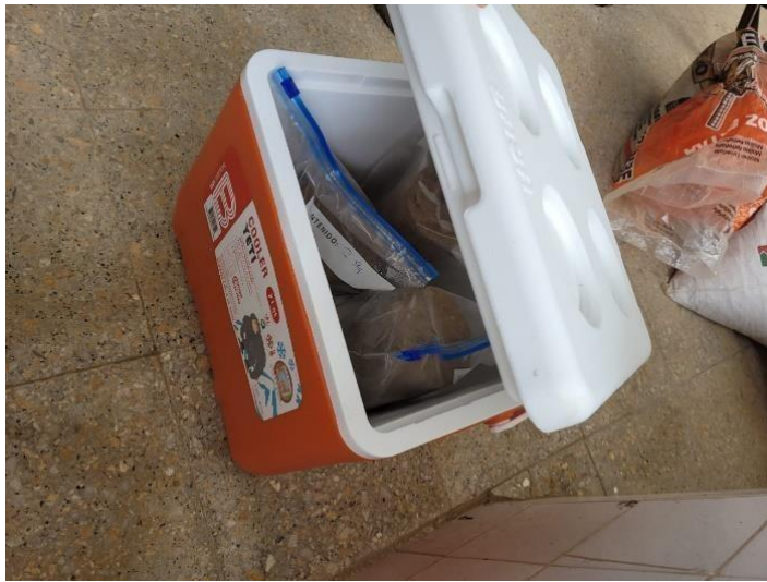
Figura 58: Se coloca otra vez las probetas en cámara de humedad por 5 horas
