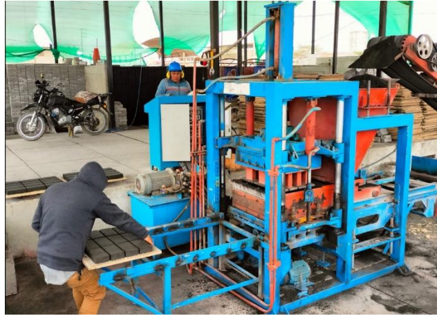
Ilustración 5: Levantamiento de tablas con bloques
