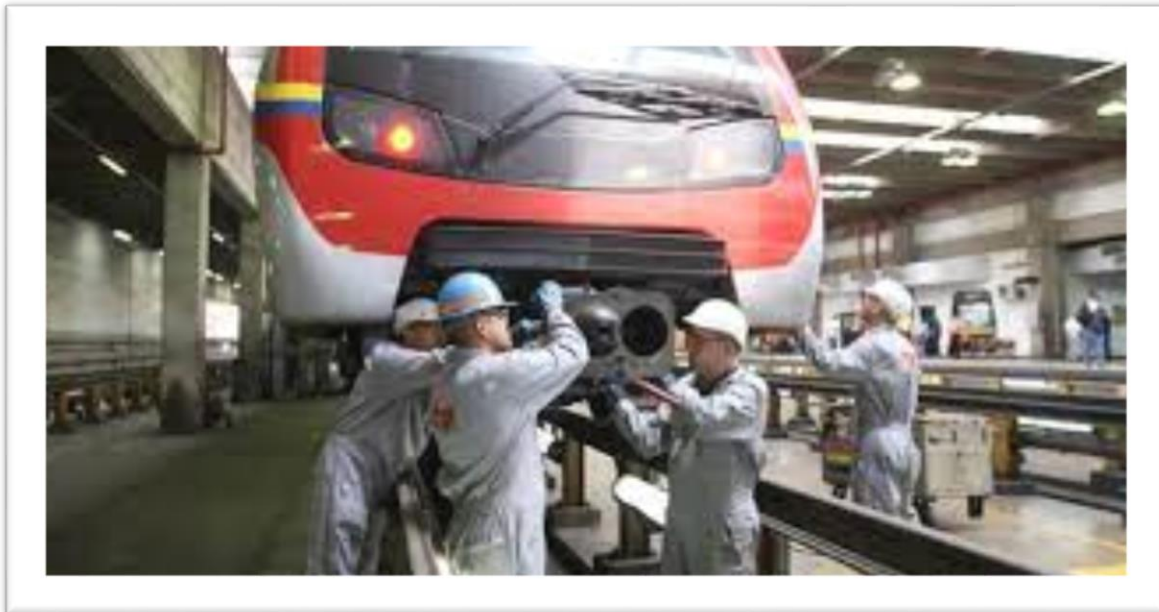
Figura 22: Mantenimiento de sistema de freno
