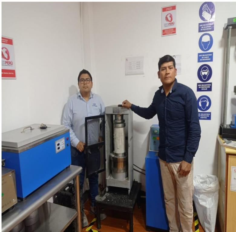
Figura 11. Rotura de probetas cilíndricas de concreto.
