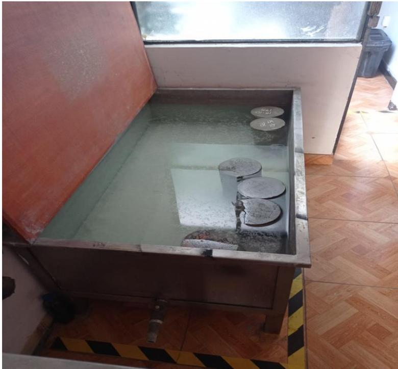
Figura 10. Curado de probetas cilíndricas de concreto.
