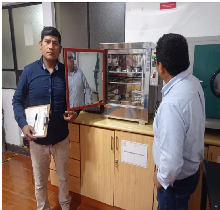
Figura 9. Secado en horno de la muestra de suelo.
