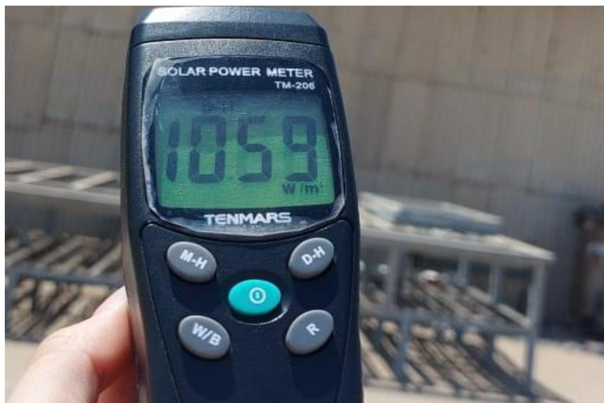
**Figura B – 6:** Medición de la irradiación con solarímetro TM – 206
