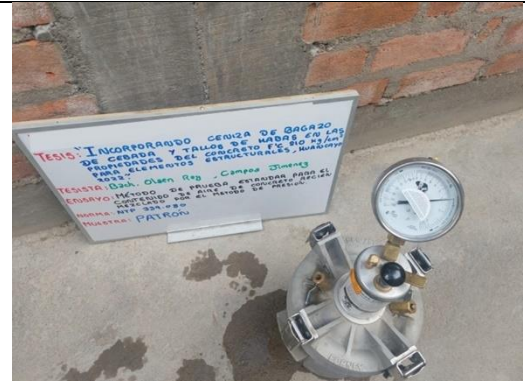
Figura 32. Ensayo contenido de aire del concreto patrón olla Washington.
