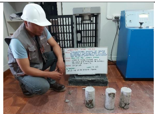
Figura 52. Ensayo resistencia a la compresión del concreto incorporando CBC al 5%, 7 días.
