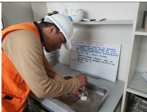
Figura 21. Ensayo densidad relativa y gravedad específica del agregado fino.
