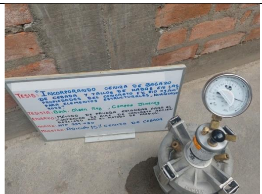
Figura 28. Ensayo contenido de aire del concreto al 15% de CBC olla Washington.
