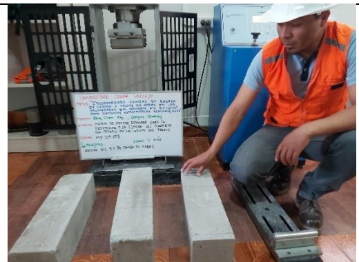
Figura 60. Ensayo resistencia a la flexión del concreto incorporando CTH al 5%, 7 días.
