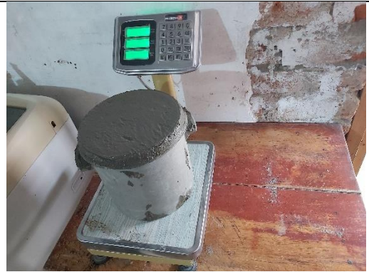
Figura 38. Ensayo de peso unitario del concreto incorporando CTH.
