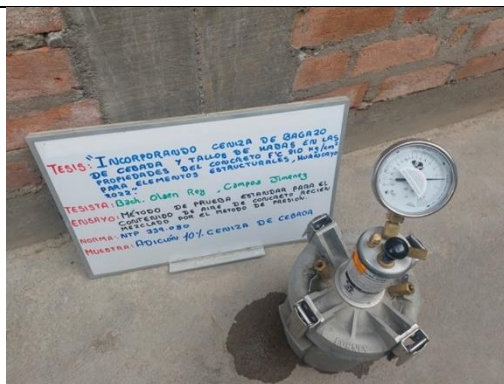
Figura 27. Ensayo contenido de aire del concreto al 10% de CBC olla Washington.
