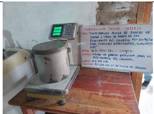
Figura 42. Ensayo de peso unitario del concreto incorporando el 15% de CBC.
