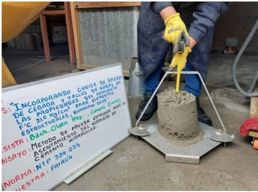
Figura 33. Ensayo del slump aplicado al concreto patrón
