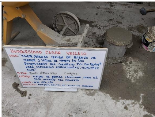
Figura 41. Ensayo de peso unitario del concreto incorporando el 15% de CBC.
