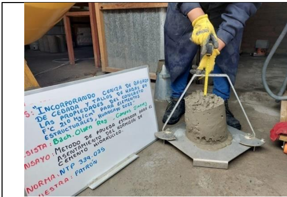
Figura 43. Ensayo del asentamiento (SLUMP) del concreto patrón.
