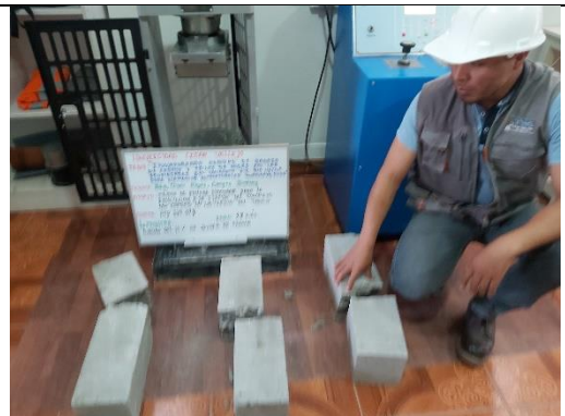
Figura 66. Ensayo resistencia a la flexión del concreto incorporando CBC al 10%, 14días
