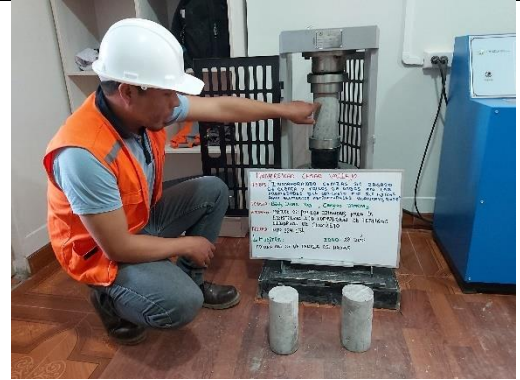
Figura 56. Ensayo resistencia a la compresión del concreto incorporando CTH al 5%, 28 días.
