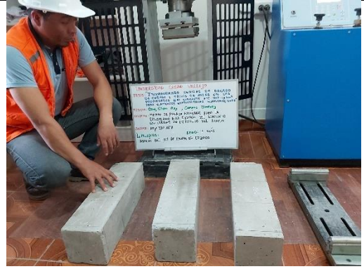
Figura 62. Ensayo resistencia a la flexión del concreto incorporando CBC al 5%, 7días
