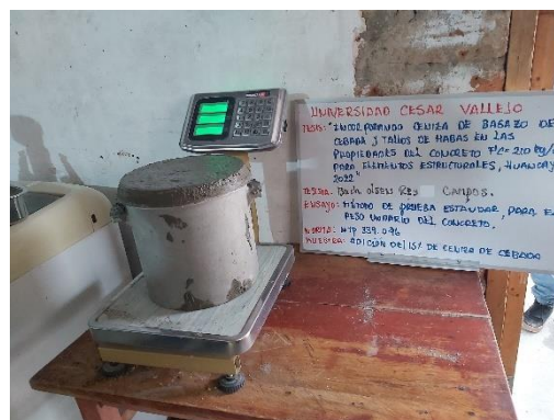
Figura 31. Ensayo del peso unitario del concreto incorporando CBC – CTH en 5;10;15%
