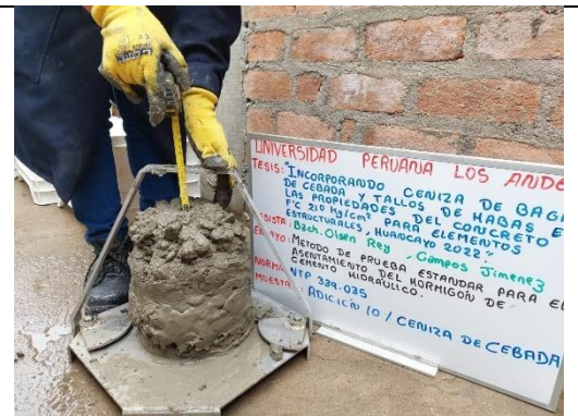
Figura 48. Ensayo del asentamiento (SLUMP) del concreto incorporando 10% CBC.
