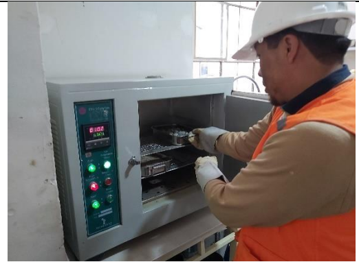
Figura 20. Secado del agregado grueso.
