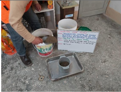
Figura 25. Ensayo densidad aparente del agregado fino (peso unitario).
