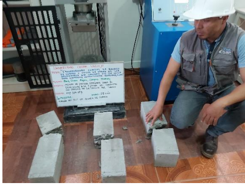
Figura 67. Ensayo resistencia a la flexión del concreto incorporando CBC al 10%, 28 días
