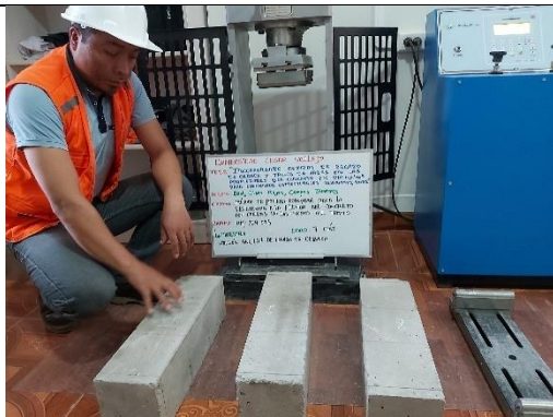
Figura 65. Ensayo resistencia a la flexión del concreto incorporando CBC al 5%, 14días
