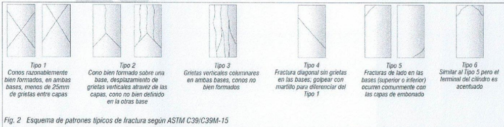
Fig. 2 Esquema de patrones típicos de fractura según ASTM C39/C39M-15
