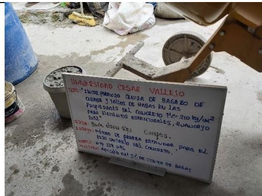
Figura 35. Ensayo de peso unitario del concreto incorporando el 5% de CTH.
