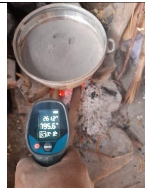
Figura 6. Control de incineración final de CBC en horno artesanal 795.6 °C.
