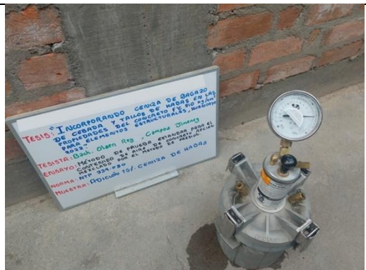
Figura 30. Ensayo contenido de aire del concreto al 10% de CTH olla Washington.
