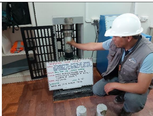
Figura 51. Ensayo resistencia a la compresión del concreto incorporando CBC al 5%, 7 días.
