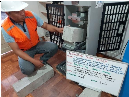
Figura 59. Ensayo resistencia a la flexión del concreto patrón a 14 días.
