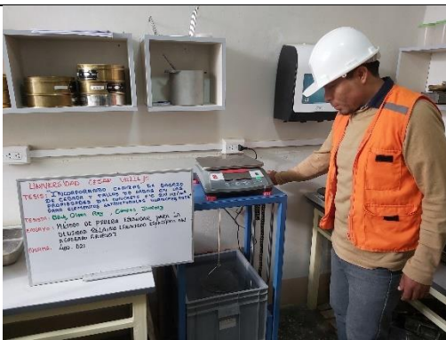
Figura 17. Ensayo densidad relativa y gravedad específica del agregado grueso.
