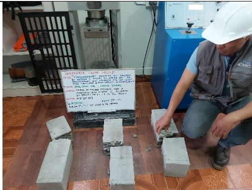
Figura 63. Ensayo resistencia a la flexión del concreto incorporando CBC al 10%, 7 días
