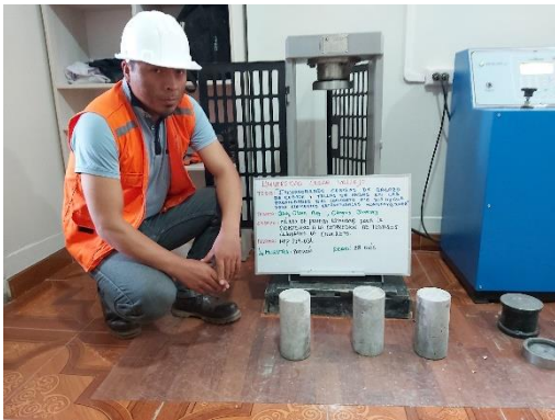
Figura 36. Ensayo de resistencia a la compresión del concreto patrón.
