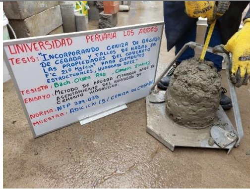
Figura 49. Ensayo del asentamiento (SLUMP) del concreto incorporando 15% CBC.
