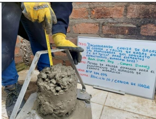
Figura 45. Ensayo del asentamiento (SLUMP) del concreto incorporando 10% CTH.
