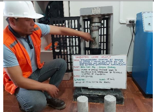
Figura 58. Ensayo resistencia a la compresión del concreto incorporando CTH al 15%, 28 días.
