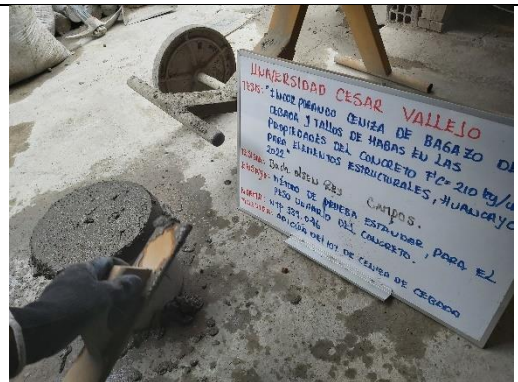
Figura 40. Ensayo de peso unitario del concreto incorporando el 10% de CBC.
