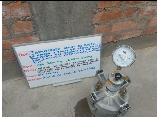
Figura 31. Ensayo contenido de aire del concreto al 15% de CTH olla Washington.
