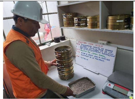
Figura 15. Análisis granulométrico del agregado fino.
