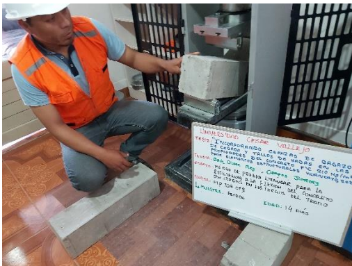
Figura 44. Ensayo de resistencia a la flexión del concreto patrón.
