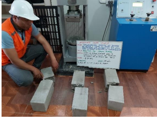
Figura 61. Ensayo resistencia a la flexión del concreto incorporando CTH al 10%, 7días.
