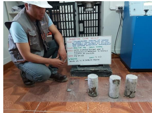
Figura 37. Ensayo de resistencia a la compresión del concreto, incorporando CBC-CTH en 5;10;15%.
