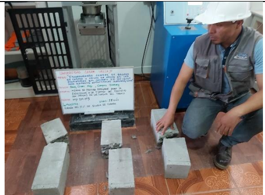
Figura 64. Ensayo resistencia a la flexión del concreto incorporando CBC al 15%, 7días
