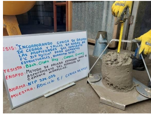
Figura 34. Ensayo del slump aplicado, al concreto incorporado con CBC - CTH en 5;10;15%
