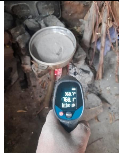
Figura 14. Control de temperatura de incineración final en horno artesanal 768.10 °C
