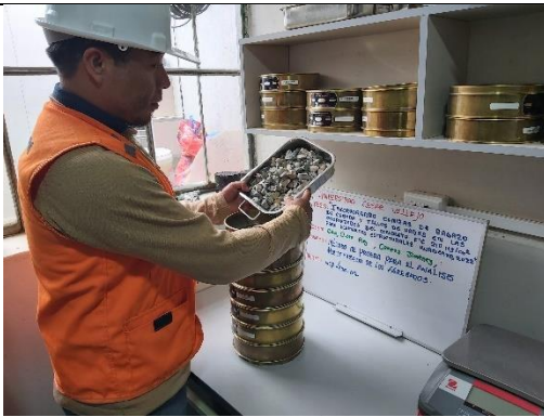
Figura 15. Análisis granulométrico del agregado grueso.
