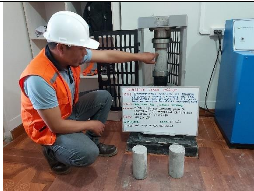
Figura 57. Ensayo resistencia a la compresión del concreto incorporando CTH al 10%, 28 días.
