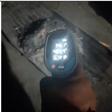
Figura 3. Control de temperatura de incineración primaria de BC a 483.4 °C.
