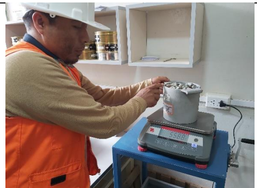
Figura 24. Ensayo densidad aparente del agregado grueso (peso unitario).
