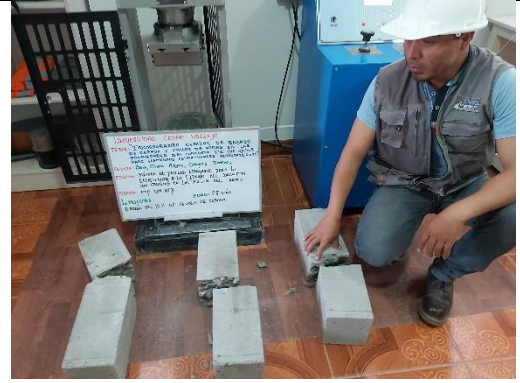
Figura 68. Ensayo resistencia a la flexión del concreto incorporando CBC al 15%, 28 días
