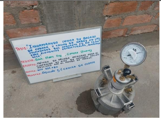
Figura 26. Ensayo contenido de aire del concreto al 5% de CBC olla Washington.
