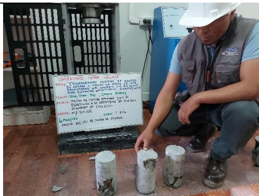
Figura 53. Ensayo resistencia a la compresión del concreto incorporando CBC al 15%, 7 días.
