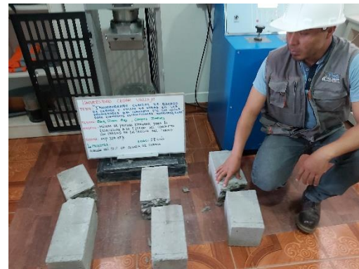
Figura 45. Ensayo de resistencia a la flexión del concreto, incorporando CBC-CTH en 5;10;15%.
