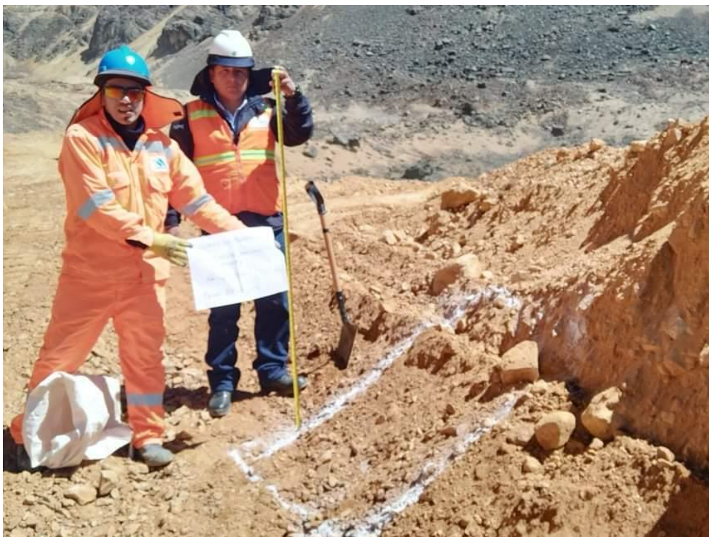
Figura 32 Calicata 1 prog. 3+ 050 profundidad 1.5 m
