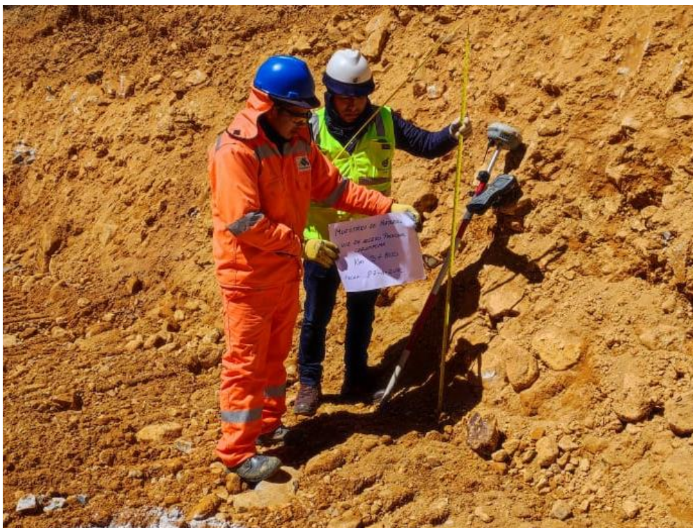
Figura 38 Calicata 3 prog. 3+800 profundidad 1.5 m
