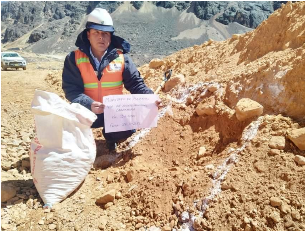
Figura 32 Calicata 1 prog. 3+ 050 profundidad 1.5 m
