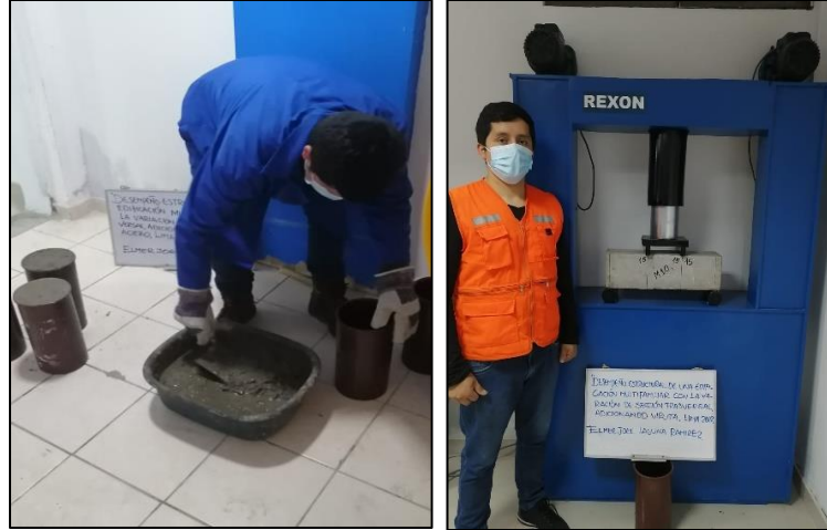
Figura 9. Elaboración de probetas y evaluación de resistencia a flexión, compresión y tracción probetas con dosificaciones de 0%, 2% y 8%.
