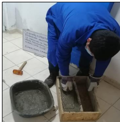
Figura 4. Elaboración de muretes de concreto.
