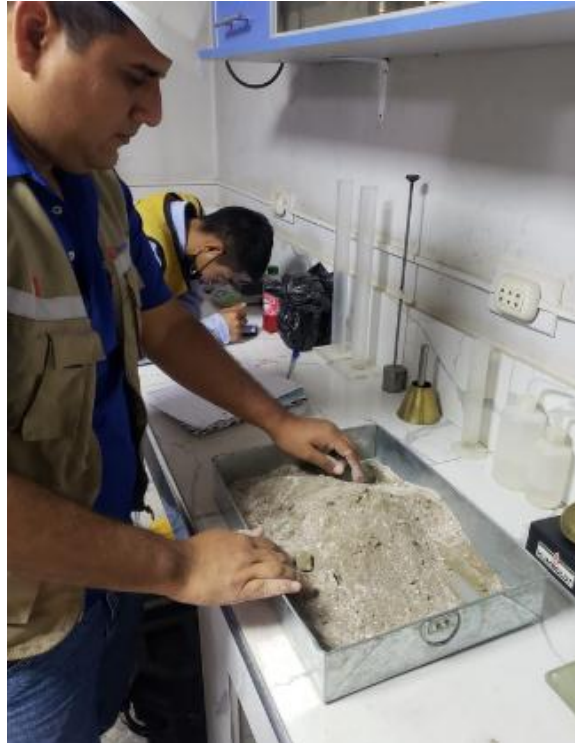
.Se realizó la mezcla de ceniza de carbón vegetal en muestra de suelo natural en los porcentajes establecidos.
