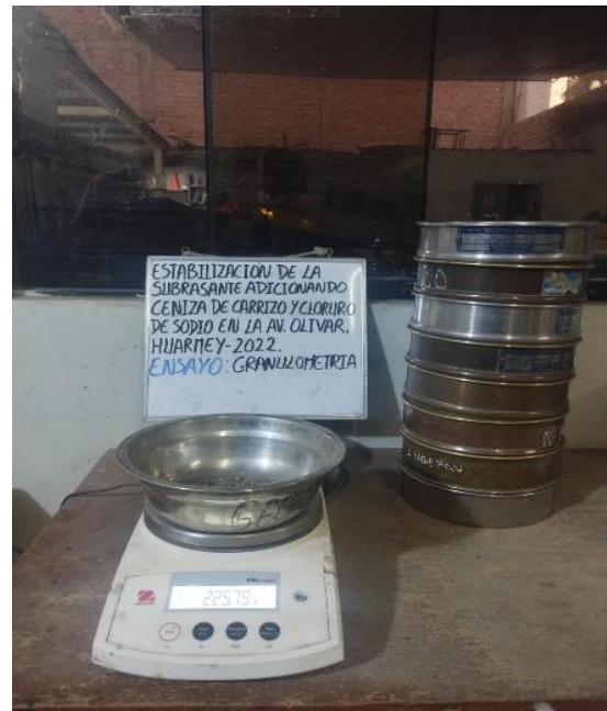
Ensayo de granulometría Fuente: elaboración propia,2022.
