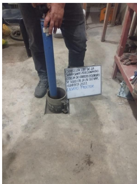
Figura N° 20: Ensayo de Proctor Fuente: Elaboración propia
