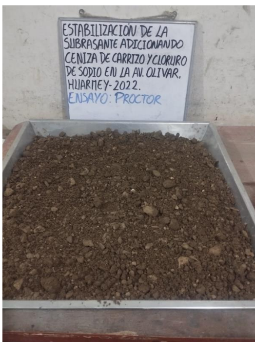
Figura N° 19: muestra ensayo de Proctor Fuente: Elaboración propia
