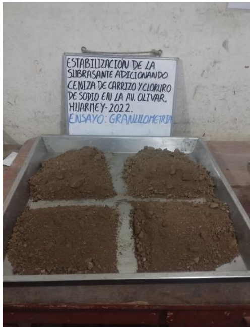
Ensayo de granulometría Fuente: elaboración propia,2022.
