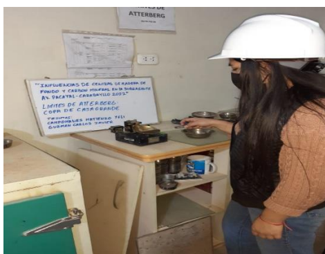
Figura 18. Muestra Húmeda en la Copa de Casa Grande Fuente: Elaboración propia
