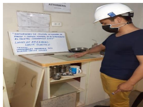
Figura 19. Determinación del límite plástico con pequeños rollos Fuente: Elaboración propia
