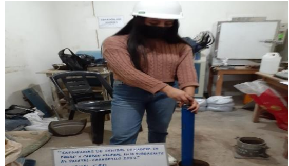
Figura 23. Ensayo de Proctor modificado de CMF
