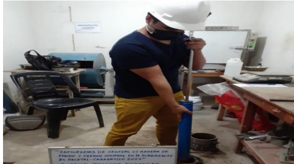
Figura 22. Ensayo de Proctor modificado de CCM
