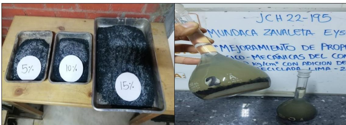
**Figura 18.** Ensayo de Peso Específico de Vidrio y Caucho Reciclado
