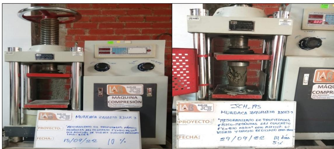
Figura 24. Ensayo de Resistencia a Compresión
