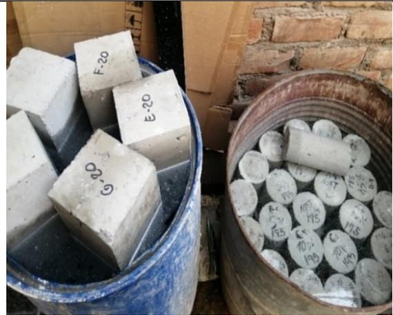
Imagen 17. Curado de Especímenes y Vigas
