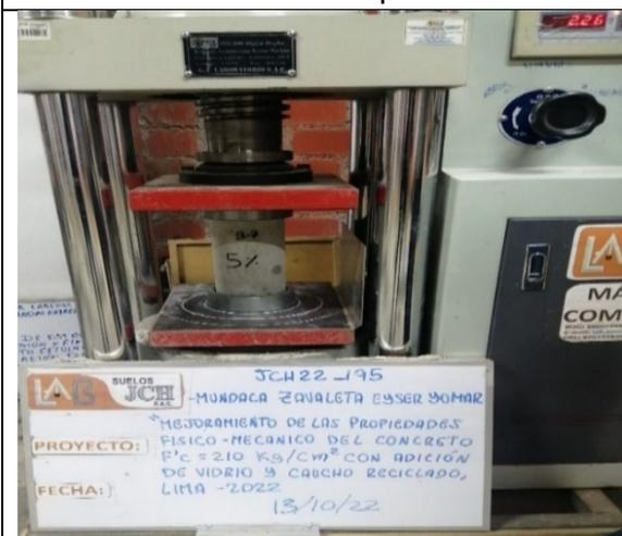
Imagen 20. Ensayo a Compresión – 28 días
