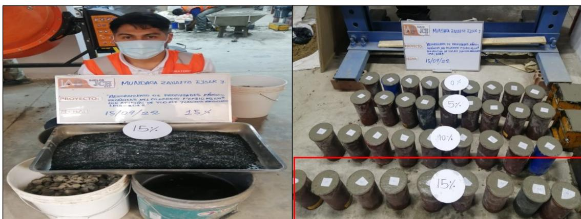
**Figura 14. Preparación de mezcla con 15% de vidrio y caucho reciclado**
