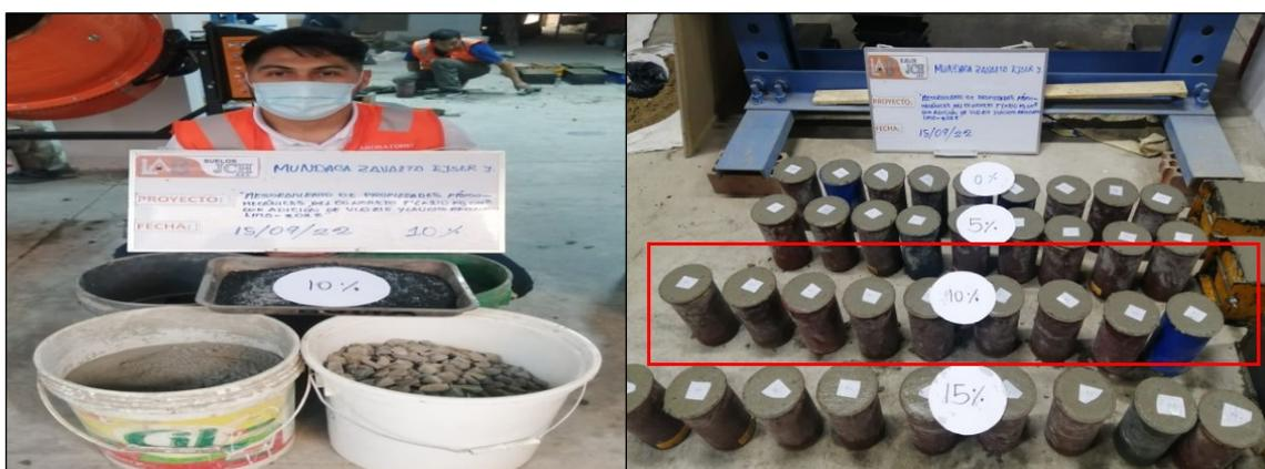
**Figura 13. Preparación de mezcla con 10% de vidrio y caucho reciclado**
