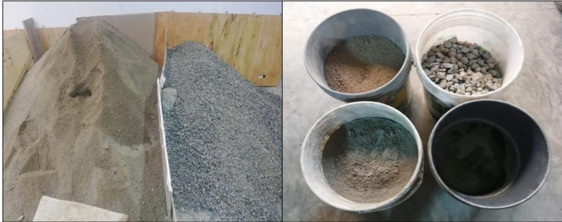
*Figura 15.* Agregado grueso y agregado fino
