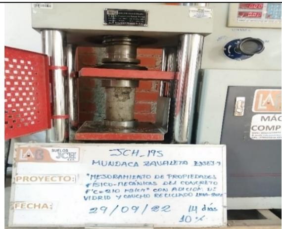
Imagen 19. Ensayo a Compresión – 14 días
