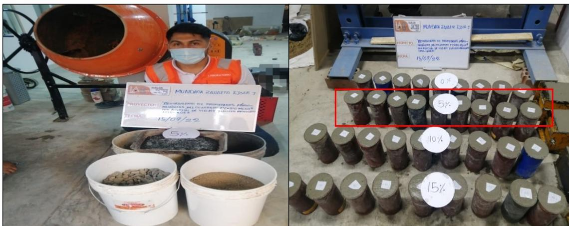
Figura 12. Preparación de mezcla con 5% de vidrio y caucho reciclado
