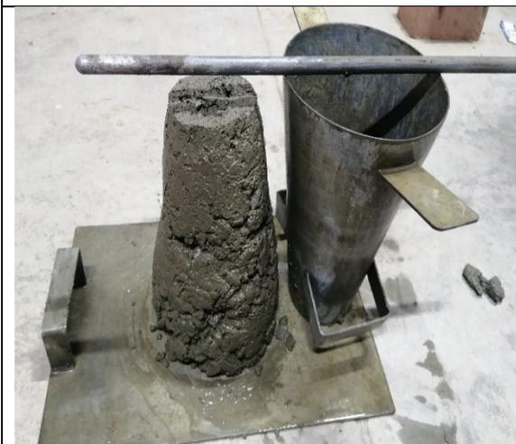
*Imagen 14. Revenimiento del Concreto*
