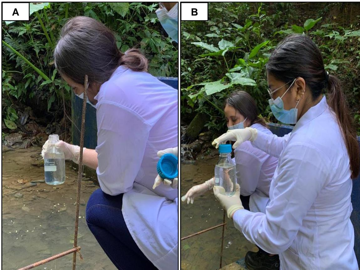
**Nota.** (A), Recolección de muestra según la RD N° 2254 - 2007 – DIGESA – SA y (B), procedimiento cierre hermético de la muestra recolectada.
