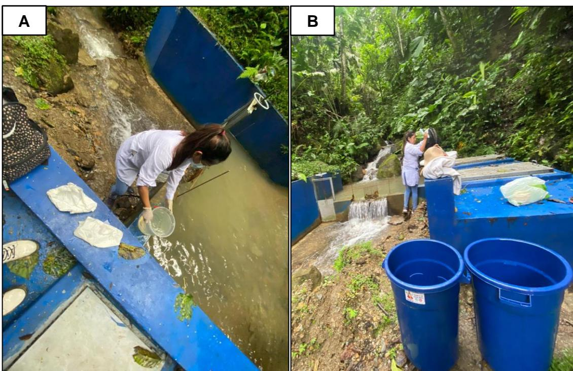
**Nota.** (A), homogenización de los envases con el cuerpo de agua y (B), timbos con cierre hermético.
