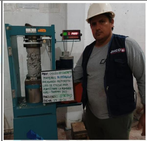
Fotos n° 19-20: En las imágenes podemos observar la resistencia a la compresión axial de los testigos de concreto
