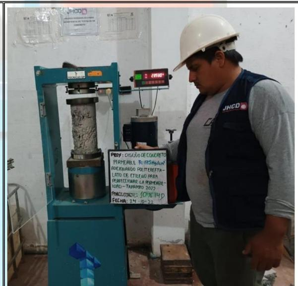
Fotos n° 21-22: En las imágenes podemos observar la resistencia a la compresión axial de los testigos de concreto
