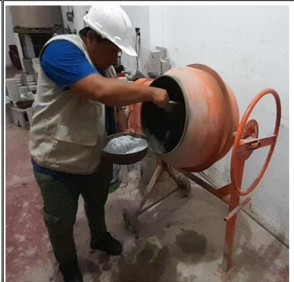
Fotos n° 09-10: En las imágenes podemos apreciar los materiales a utilizar para el diseño de concreto con adición de Politereftalato de Etileno.p
