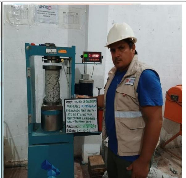
Fotos n° 25-26: En las imágenes podemos observar la resistencia a la compresión axial de los testigos de concreto.
