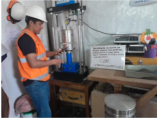
Imagen 37: Ensayo de CBR según dosificaciones
