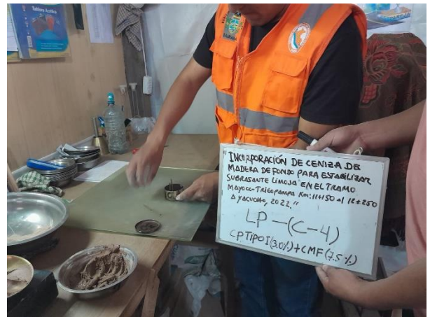
Imagen 30: Mezclado de cemento, ceniza de madera y suelo natural según dosificaciones
