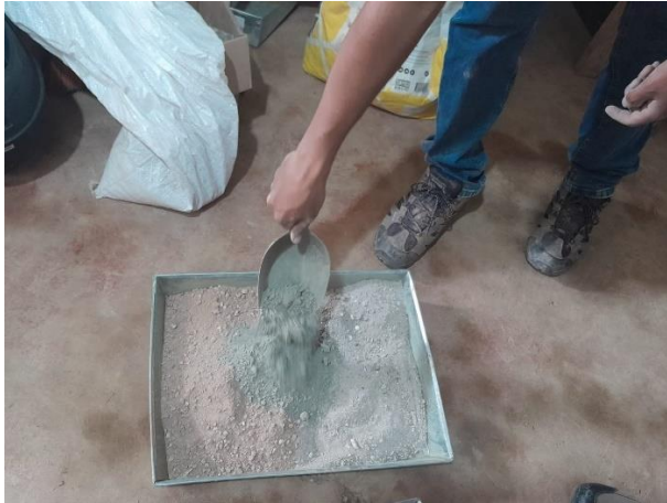
Imagen 21: Mezclado de cemento, ceniza de madera y suelo natural según dosificaciones
