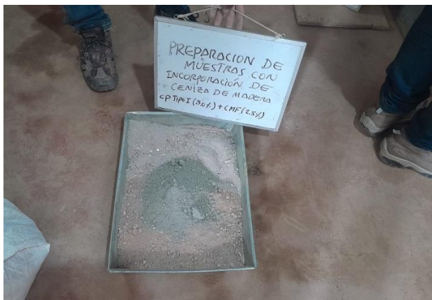
Imagen 23: Mezclado de cemento, ceniza de madera y suelo natural según dosificaciones
