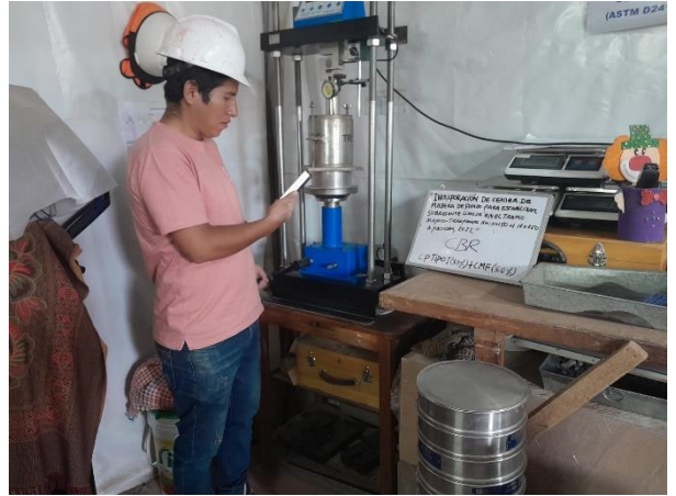
Imagen 38: Ensayo de CBR según dosificaciones
