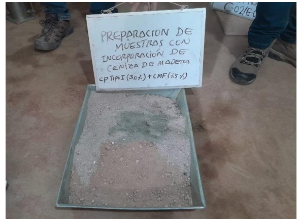
Imagen 24: Mezclado de cemento, ceniza de madera y suelo natural según dosificaciones
