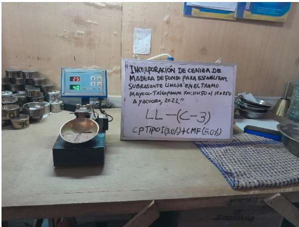
Imagen 33: Ensayo de Limite liquido según dosificaciones
