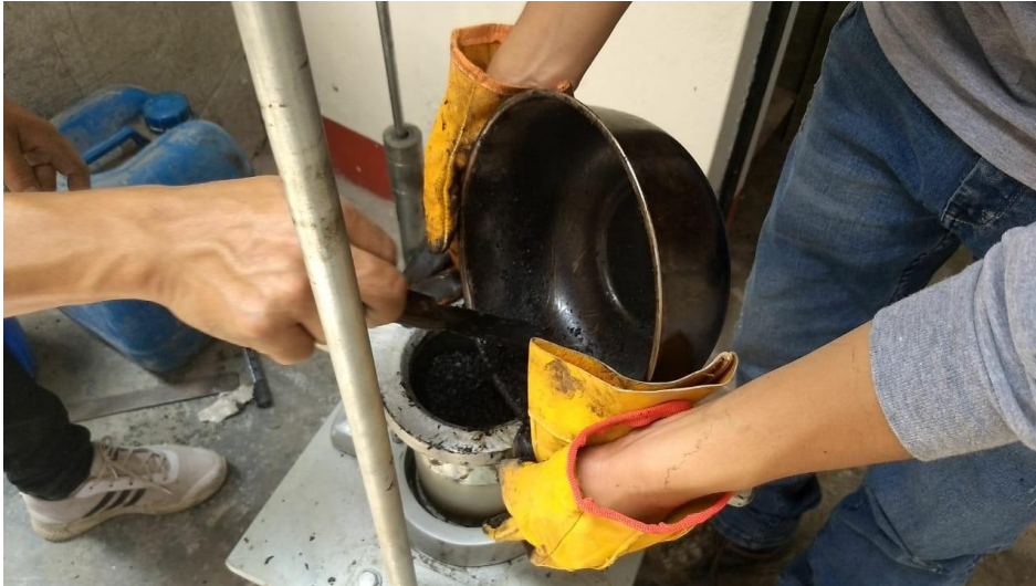
Preparación de briqueta
