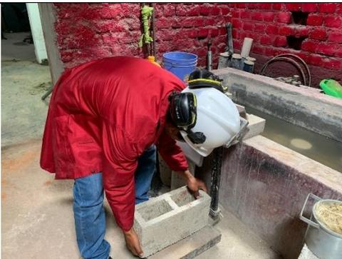
Ensayo de absorción, peso en seco mediante uso de la balanza Henkel.
