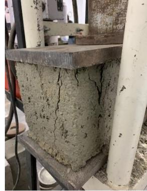
*Figura 19. Rotura de bloque de concreto patron a los 7 días de edad.*
