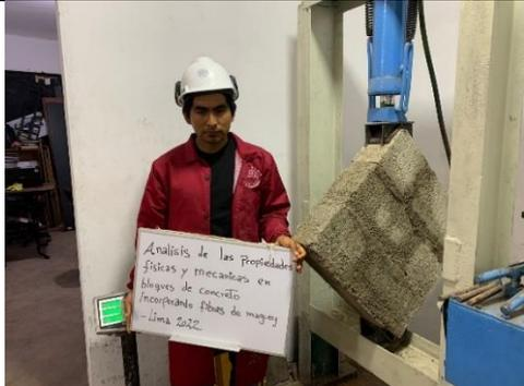
Ensayo de resistencia a la compresión a los 28 días en murete.
