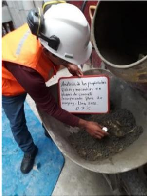
Figura 12. Toma de temperatura en el concreto con incorporación de fibra de maguey al 0.7%.
