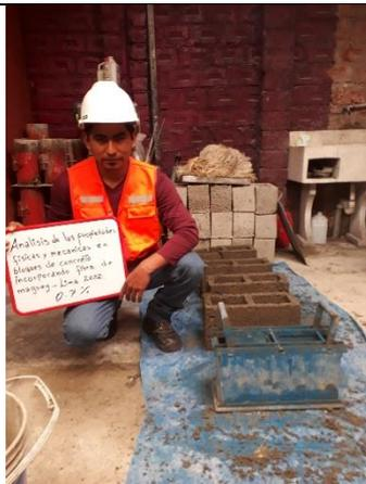
Fabricación de bloques de concreto con 0.7% de fibra de maguey.
