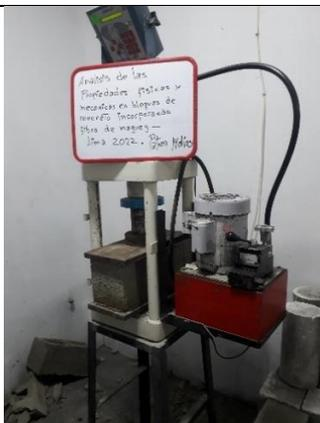
Ensayo de resistencia a la compresión bloque patrón a los 14 días de edad.
