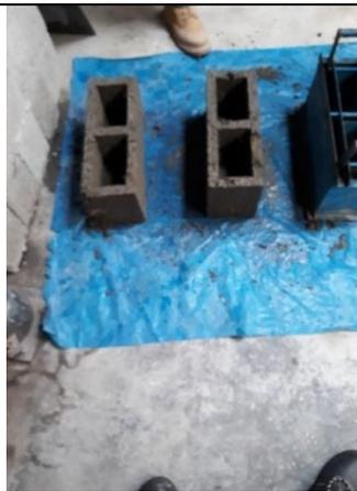
Moldeado de bloques de concreto con 0.7% de fibra de maguey.
