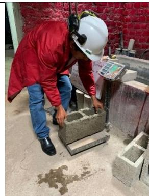
Ensayo de absorción, peso del bloque sumergido en agua, uso de la balanza Henkel.
