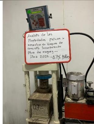
Ensayo de resistencia a la compresión a 7 días de edad con 0.7% de fibra de maguey.
