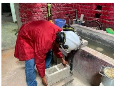
Figura 15. Ensayo de absorcion, toma de datos (peso) del bloque de concreto en estado seco a los 7 dias de edad.
