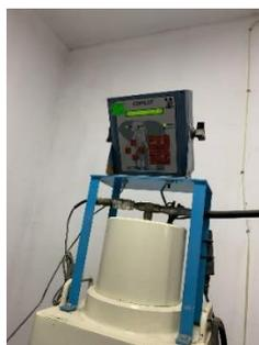
Figura 21. Control de cargas digital según la prensa hidraulica
