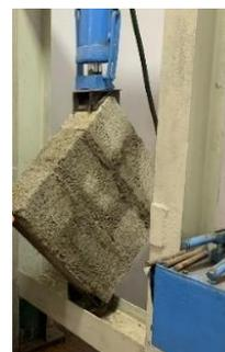
Figura 22. Ensayo de resistencia a la compresion (murete ) a los 28 dias de edad.
