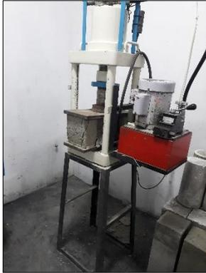
*Figura 18. Ensayo de resistencia a la compresión por unidad con la maquina de ensayo uniaxial (bloque de concreto patron).*
