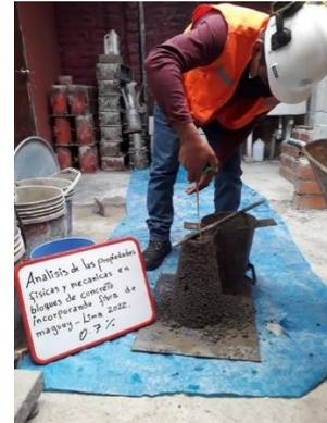
Figura 13. Ensayo de slump (cono de Abrams) con la incorporación de fibra de maguey al 0.7%.
