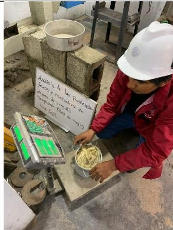
Obteniendo el peso mediante la balanza Henkel.
