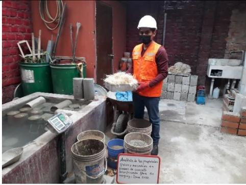
Cantidad de materiales según diseño de mezcla con 0.7% de fibra de maguey.
