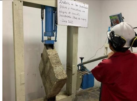
Ensayo corte diagonal en murete a los 28 días de edad.
