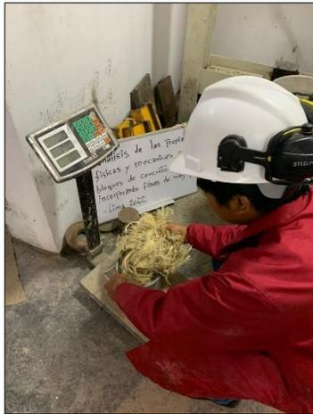
Figura 10. Ensayo de densidad, peso de la fibra de maguey, mediante el uso de la balanza y el recipiente cilíndrico.
