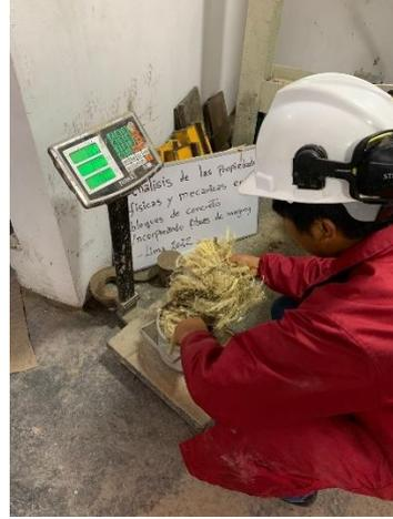
Colocando la fibra al cilindro de  $0.00277\text{cm}^3$  con un peso de 3.65 kg.
