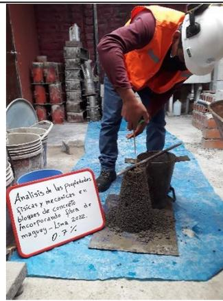
Ensayo de Slump con incorporación de 0.7% de fibra de maguey.
