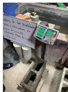
Figura 16. Ensayo de absorcion, toma de datos (peso) sumergido en agua bloque de concreto a los 7 dias de edad.
