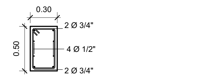
5 Sección Viga Principal 1 : 25
