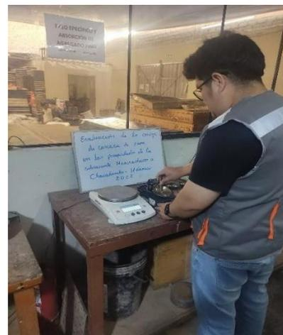
**Figura 20:** Ensayo de Límites de Atterberg
