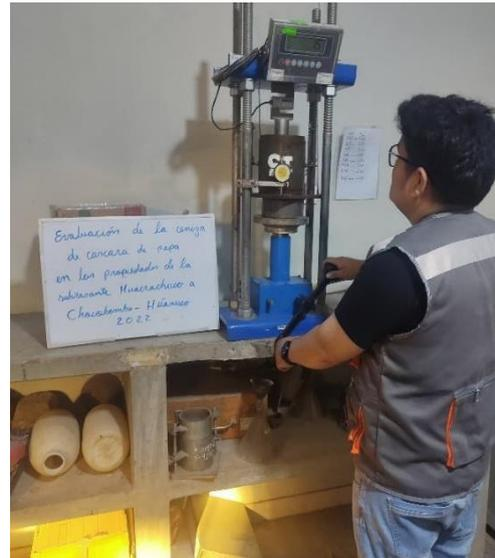
**Figura 27:** Ensayo de CBR
