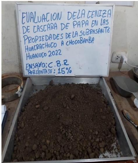
**Figura 26:** Ensayo de CBR
