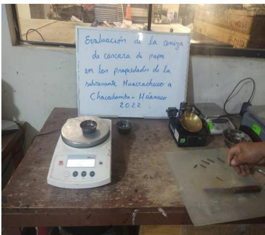
**Figura 19:** Ensayo de análisis granulométrico
