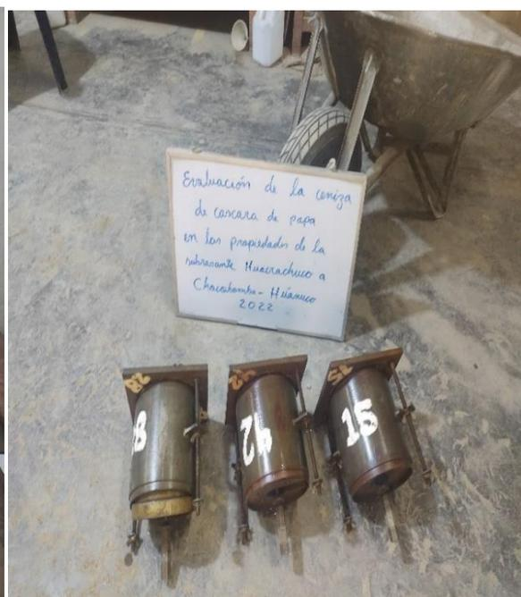
**Figura N° 23:** Ensayo de Proctor modificado
